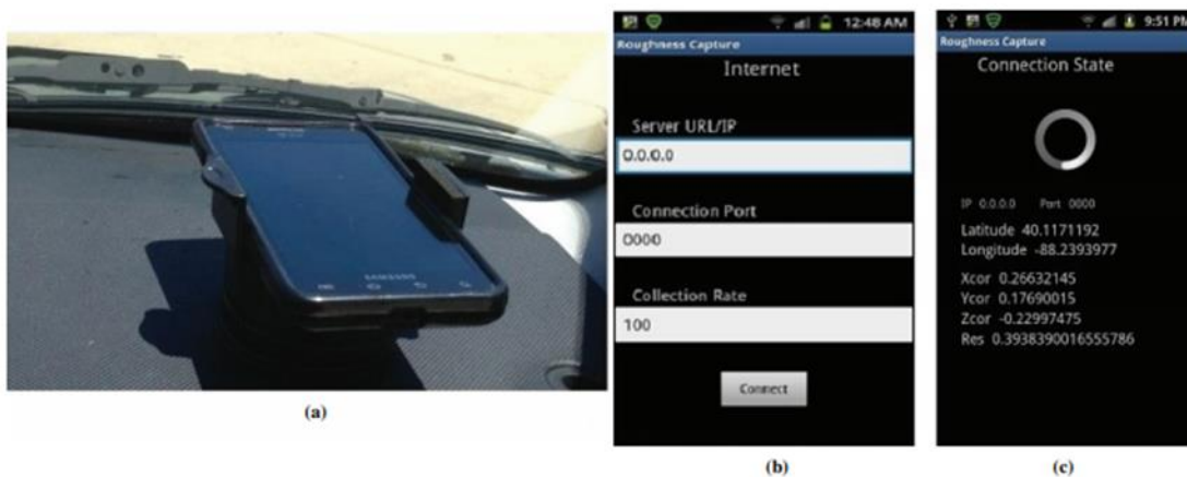
Εικόνα 2.14. Σύστημα Roughness Capture που βασίζεται σε smartphone: (a) εφαρμογή κινητού τηλεφώνου που καταγράφει κάθετη επιτάχυνση, (b) Roughness Capture interface και (c) καταγραφή δεδομένων επιτάχυνσης (Islam et al. , 2014)
