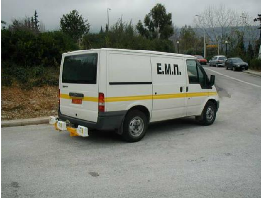
Εικόνα 2.8. Road Surface Profiler του Εργαστηρίου Οδοποιίας ΕΜΠ (υψηλής ταχύτητα προφιλόμετρο) (Λοΐζος και Πλατή,2018)
