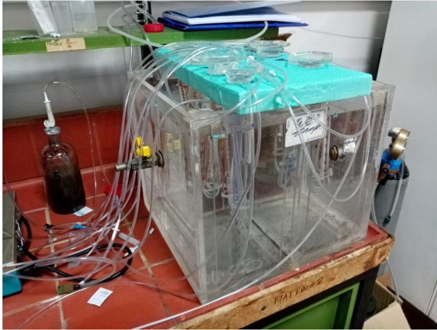
Εικόνα 3.11 Δεξαμενή μέτρησης παραγόμενου βιοαερίου με αντεστραμμένους ογκομετρικούς κυλίνδρους
