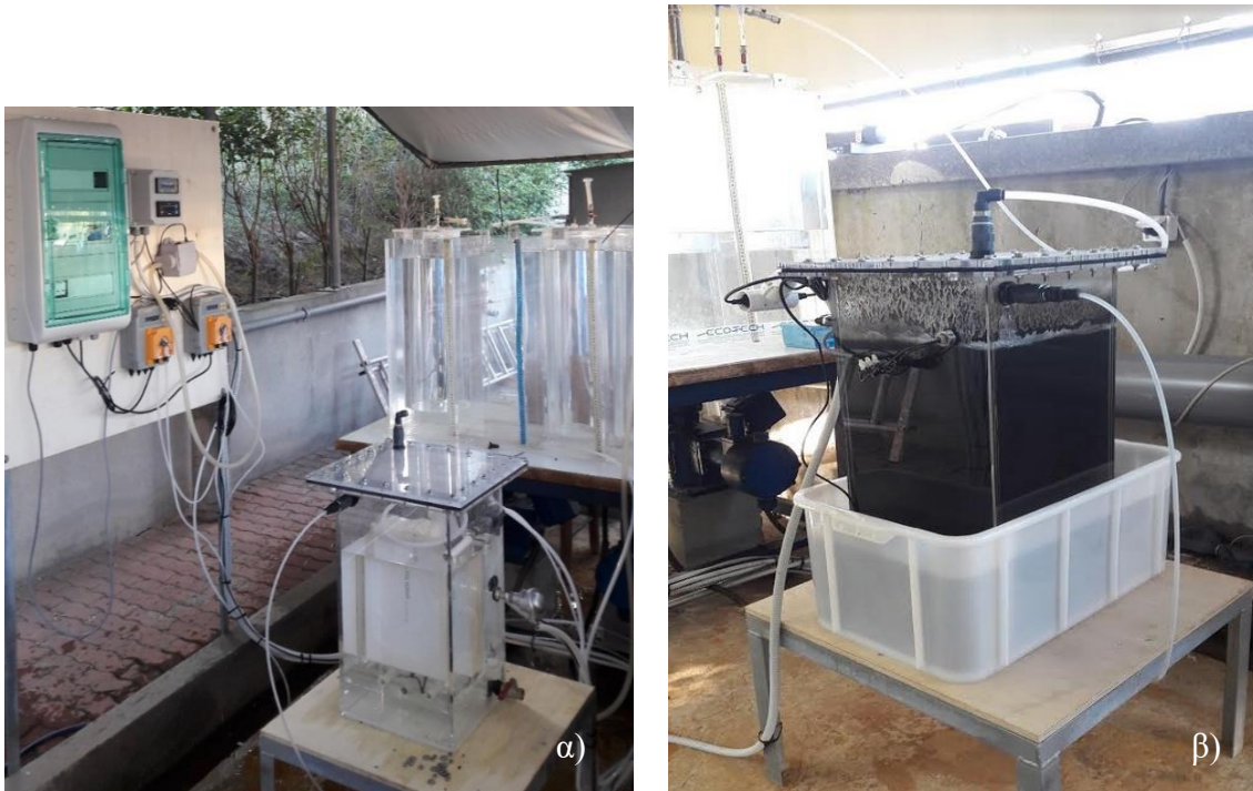
Εικόνα 3.1 Απεικόνιση του πιλοτικού αντιδραστήρα AnMBR α) ηλεκτρομηχανολογικός εξοπλισμός και αντιδραστήρας, β) αντιδραστήρας AnMBR με εξωτερική δεξαμενή, για τη ρύθμιση της θερμοκρασίας
