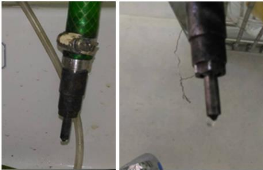
Σχήμα 4.5. Ακροφύσιο πριν (αριστερά) και μετά (δεξιά) τον καθαρισμό.
