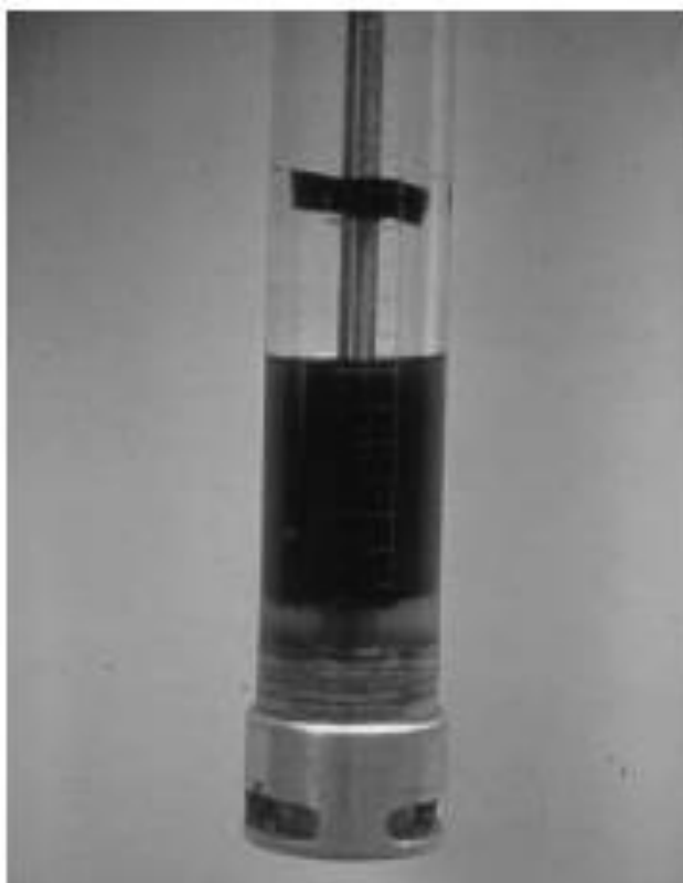
Σχήμα 3.8. Συλλογή δείγματος από διεπαφή καυσίμου - νερού.
