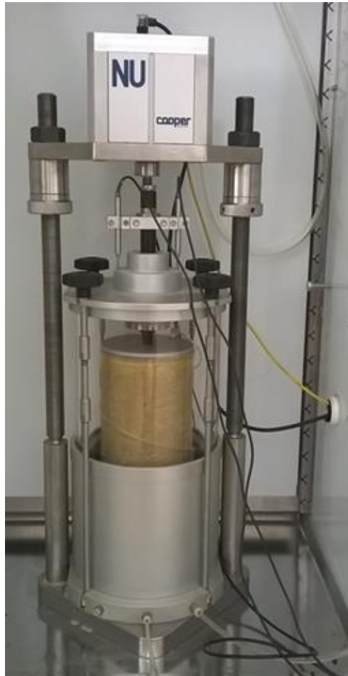
Εικόνα 3.1 Διάταξη δοκιμίου-συσκευής κατά την τριαξονική δοκιμή επαναλαμβανόμενου φορτίου
