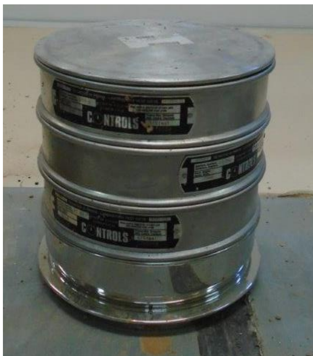
Εικόνα 5.5 Τα 4 τελευταία κόσκινα αριθμημένα σύμφωνα με το πρότυπο ΕΛΟΤ ΕΝ 933-2, 1996 (Φωτογραφία από το Εργαστήριο Οδοποιίας του ΕΜΠ)
