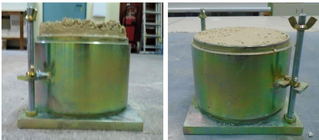
Εικόνα 4.2 Αριστερά φαίνεται η μήτρα με το δοκίμιο μετά την αφαίρεση του παρεμβλήματος και δεξιά φαίνεται η μήτρα με το δοκίμιο αφού το υλικό επιπεδωθεί (Φωτογραφίες από το Εργαστήριο Οδοποιίας του ΕΜΠ)
