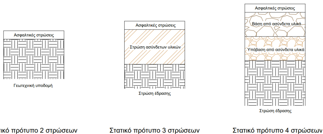
Εικόνα 7.4 Στατικά πρότυπα μελέτης εύκαμπτου οδοστρώματος
