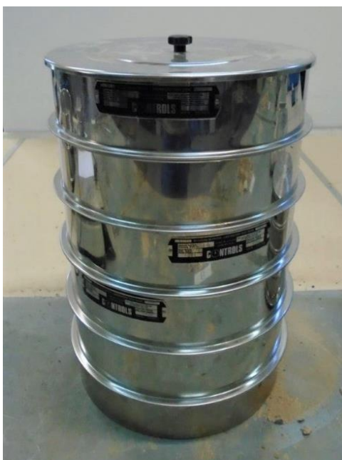
Εικόνα 5.4 Τα πρώτα 6 κόσκινα αριθμημένα σύμφωνα με το πρότυπο ΕΛΟΤ ΕΝ 933-2, 1996 (Φωτογραφία από το Εργαστήριο Οδοποιίας του ΕΜΠ)
