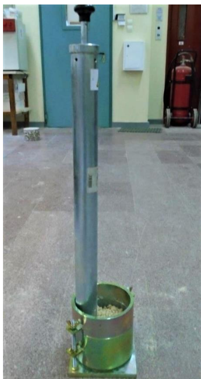
Εικόνα 5.9 Διάταξη δοκιμίου κατά τη δοκιμή συμπίκνωσης. Εδώ φαίνονται η μήτρα και ο κόπανος που χρησιμοποιήθηκαν στο εργαστήριο (Φωτογραφία από το Εργαστήριο Οδοποιίας του ΕΜΠ)
