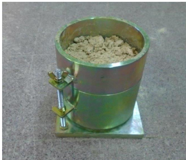
Εικόνα 4.1 Δοκίμιο μέσα στη μήτρα που χρησιμοποιείται στη δοκιμή συμπίκνωσης (Φωτογραφία από το Εργαστήριο Οδοποιίας του ΕΜΠ)
