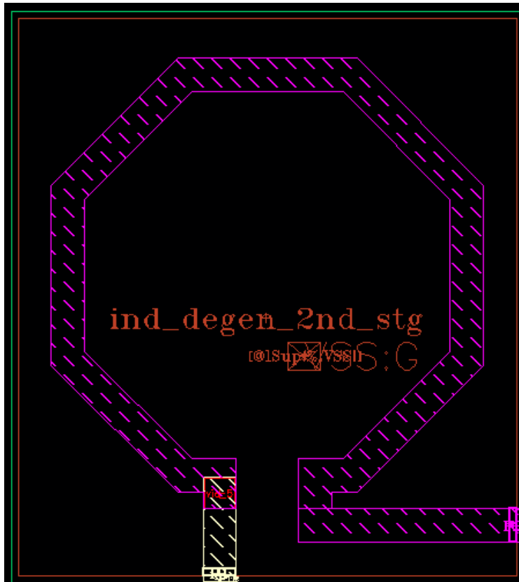
Εικόνα 4-6 Φυσική σχεδίαση πηνίου εκφυλισμού δευτέρου σταδίου
