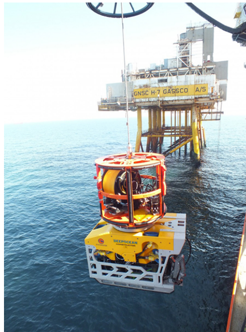
Εικόνα 5-16. Καθέλκυση ROV για την πλήρη εκκαθάριση του πυθμένα μετά τον παροπλισμό και απομάκρυνση υπεράκτιας εξέδρας (English, 2019)
