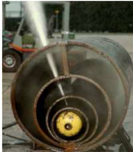
Εικόνα 5-11. Κοπή με εκτόξευση διαβρωτικής δέσμης νερού (water abrasive cutting) (Grismala, 2015)
