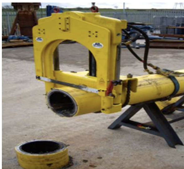
Εικόνα 5-10. Μηχανή κοπής τύπου γκιλοτίνας (guillotine saw) (Grismala, 2015)
