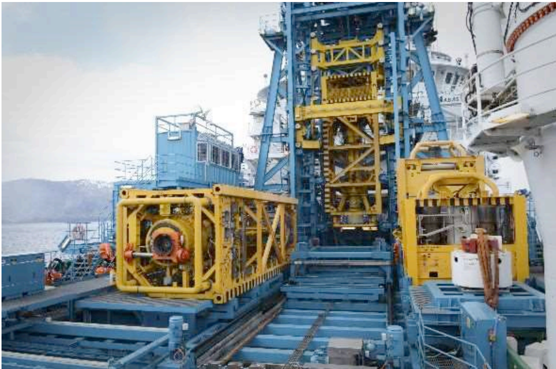
Εικόνα 4-28. Το υποθαλάσσιο σύστημα AX-S της εταιρείας Expro Group για την εκτέλεση εργασιών παρέμβασης σε γεωτρήσεις (subsea well intervention system) (Grismala, 2015)
