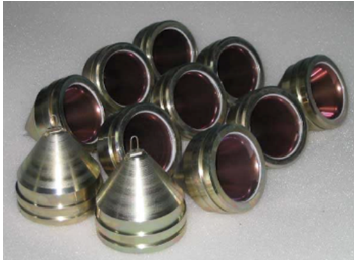
Εικόνα 5-8. Κοίλες γομώσεις εκρηκτικών (shaped charges) (Grismala, 2015)
