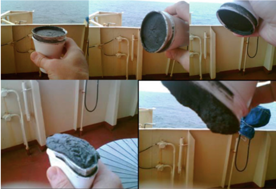
Εικόνα 4-33. Χρήση πολφού άμμου ως εναλλακτικό υλικό πώματος γεώτρησης (Khalifeh & Saasen, 2020)
