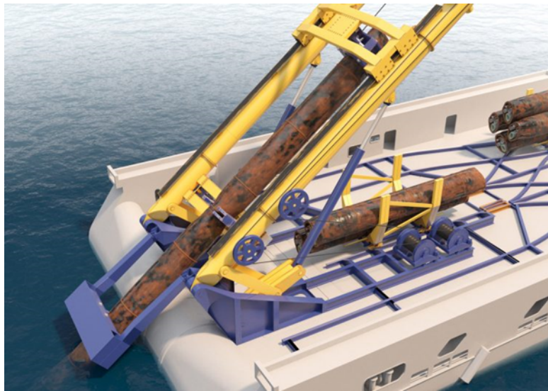
Εικόνα 5-14. Σύστημα απομάκρυνσης υπεράκτιων αγωγών (Laytrix Limited, 2019)
