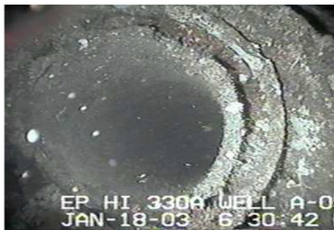
Εικόνα 4-35. Γεώτρηση από την οποία διαφεύγουν φυσαλίδες αερίου μετά τη σφράγιση και εγκατάλειψή της (Grismala, 2015)
