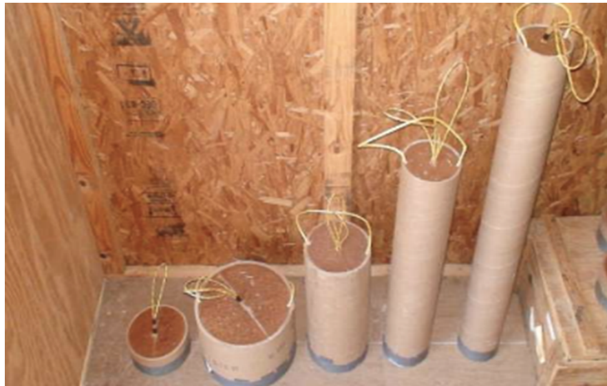
Εικόνα 5-7. Γομώσεις χύδην εκρηκτικών (bulk charges) (Grismala, 2015)
