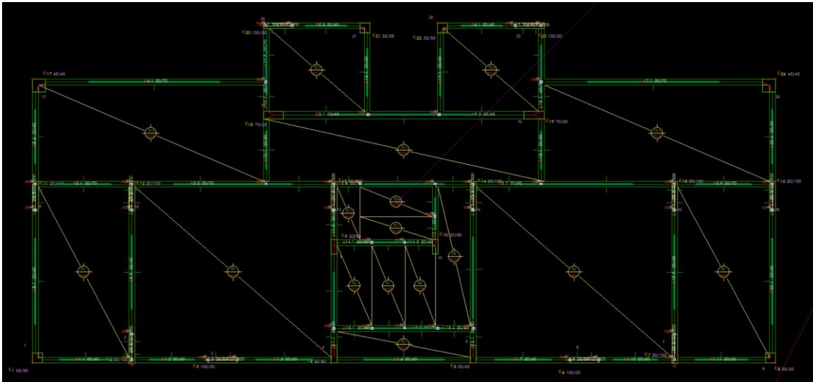
Σχήμα2.9: Ξυλότυπος οροφής Β' ορόφου
