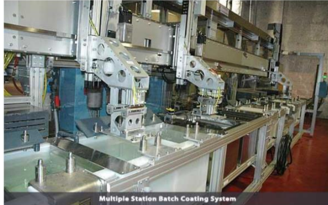
Εικόνα 18: Εφαρμογή μεθόδου dip- coating σε βιομηχανικά πλαίσια [39]
