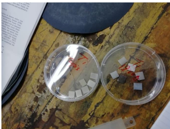
Εικόνα 20: Έξι δοκίμια τιτανίου χωρίς να έχουν υποστεί διεργασία λείανσης και έξι δοκίμια που έχουν υποστεί διεργασία λείανσης.
