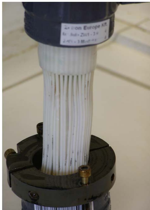
Εικόνα 4: Η μεμβράνη με τριχοειδής κοίλες ίνες που χρησιμοποιήθηκε
