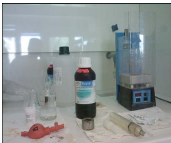
Εικόνα 2: Ειδική διάταξη για την πραγματοποίηση της χώνευσης
