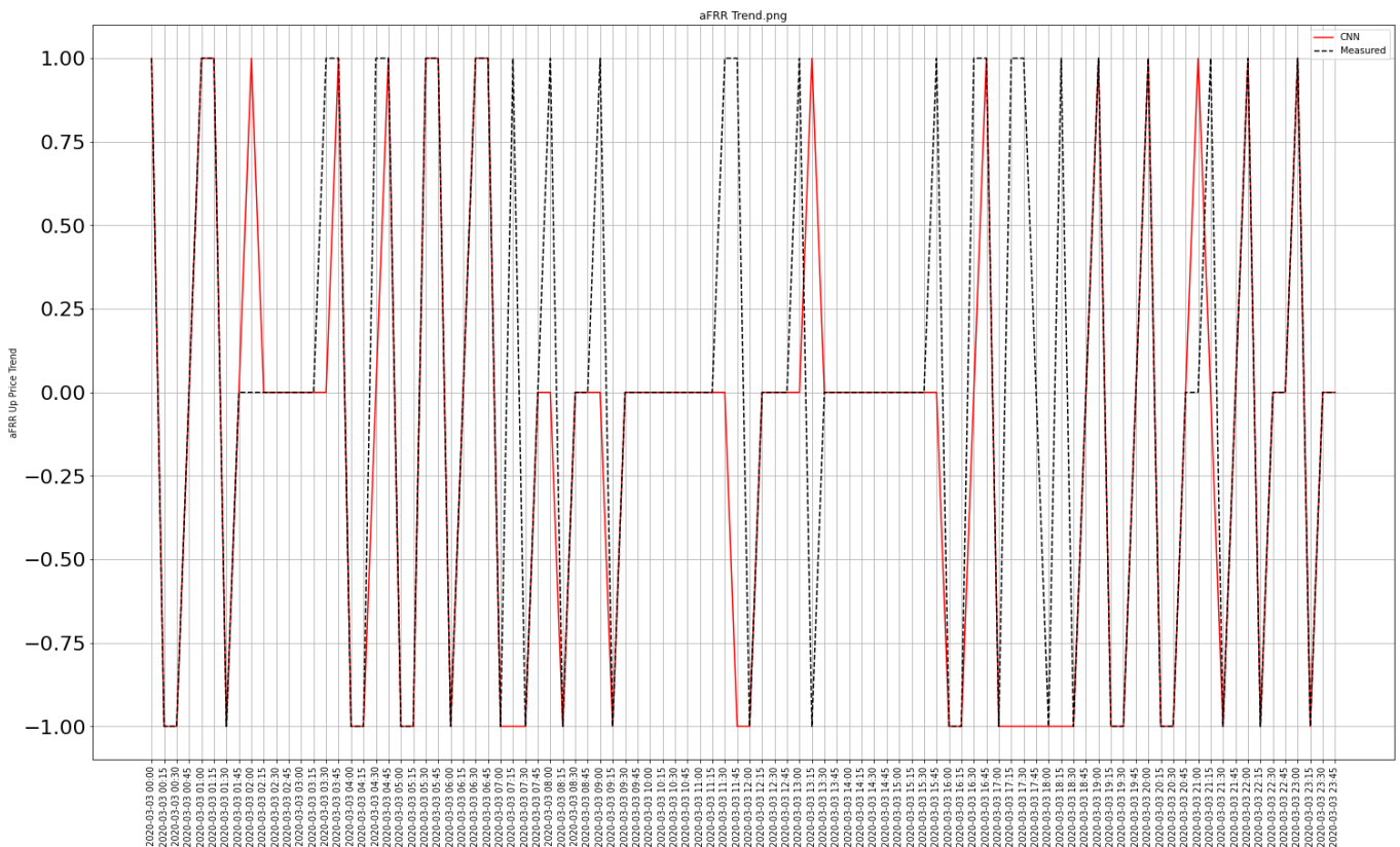
Σχήμα 4.11 Ενδεικτική πρόβλεψη του μοντέλου 5 από τον Πίνακα 4.5 για την τάση της τιμής aFRR Up για την 3η Μαρτίου 2020. Αποτελεί παράδειγμα όπου το μοντέλο παρουσιάζει πολύ καλή συμπεριφορά και μάλιστα, όπως φαίνεται στο δεξιό μέρος του σχήματος καταφέρνει να προβλέψει σωστά και περιπτώσεις που η τιμή αυξάνεται.
