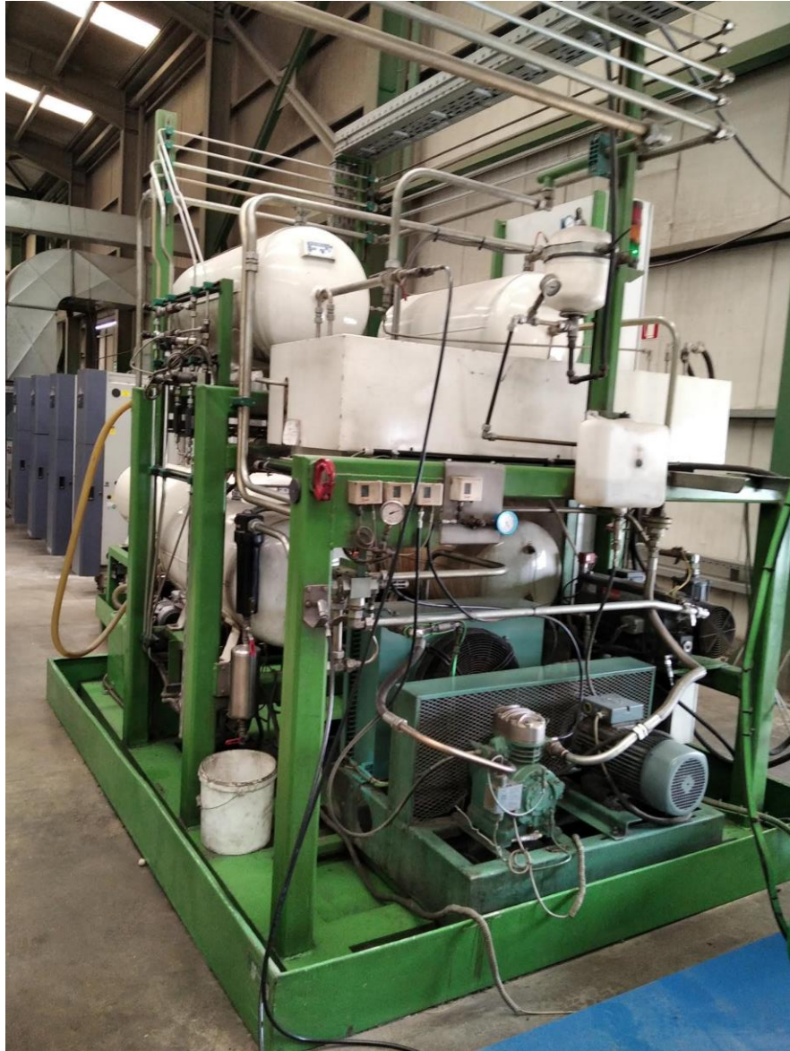
Εικόνα 22: «Κύκλωμα» διαχωρισμού ψυκτικού υγρού και λαδιού
