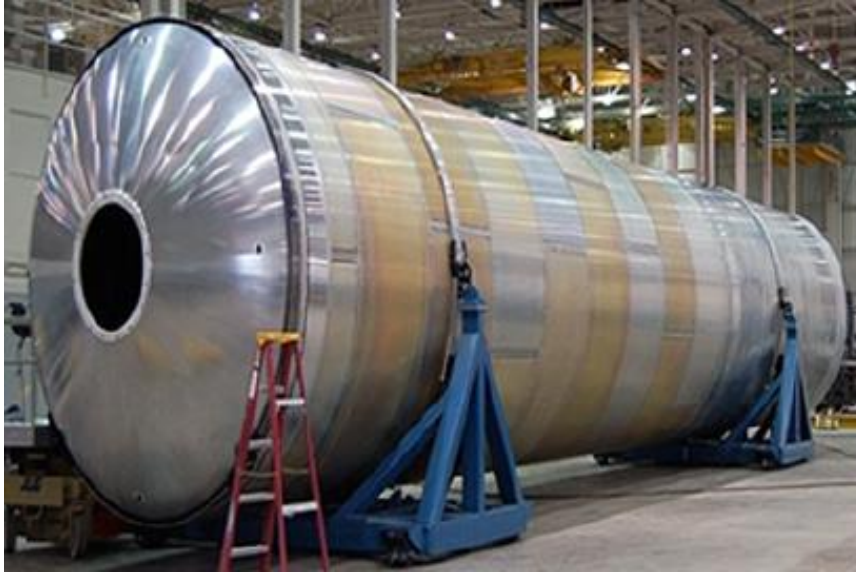
Εικόνα 1.10: Κύλινδρος σε πρώιμο στάδιο με περιστροφικό θόλο κατασκευασμένος από AA2198 για το αεροσκάφος Falcon 9. [9]
