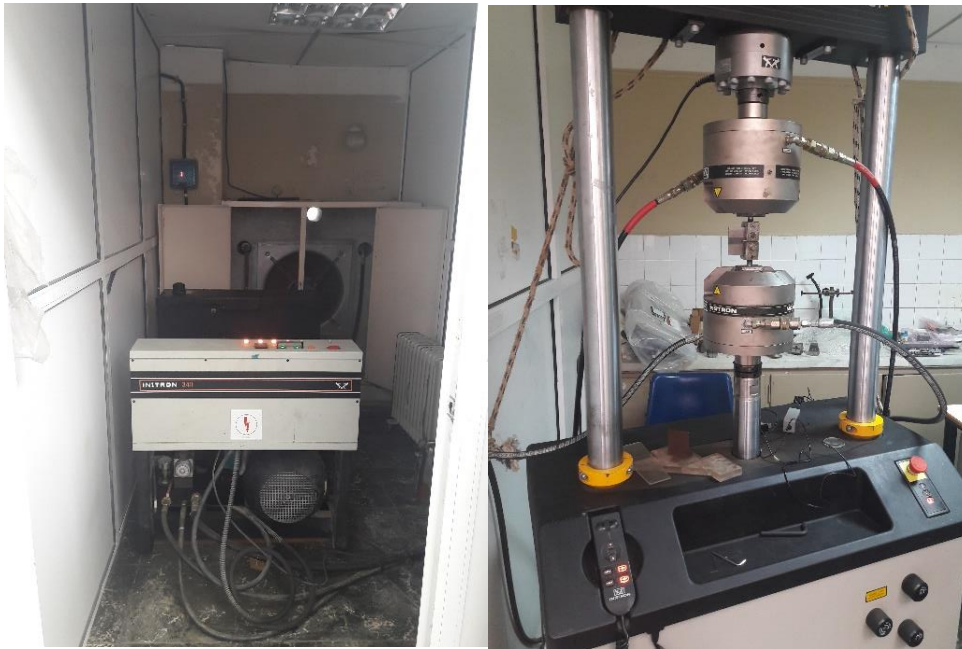
Εικόνες 2.4 και 2.5: Η πειραματική μηχανή Instron 8801 και η διάταξη κατά την εκπόνηση ενός πειράματος
