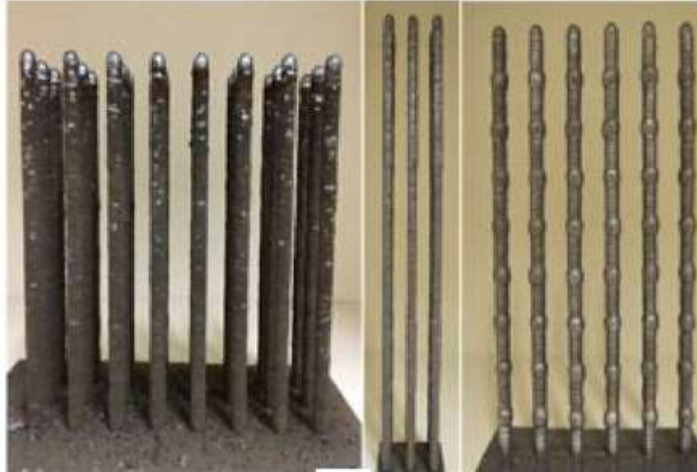
Σχήμα 4-10: Ενίσχυση εκτυπωμένου σκυροδέματος με την τεχνική CNC
