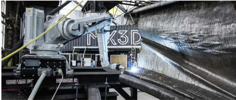
Σχήμα 3-3: Εξάρτημα μεταλλικής γέφυρας κατασκευασμένο με τον εκτυπωτή MX3D (MX3D)
