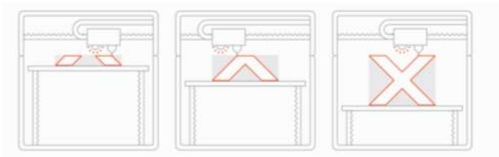
Σχήμα 2-6: Διαμόρφωση αντικειμένου με τη μέθοδο ψεκασμού υλικού (Bournias Varotsis)
