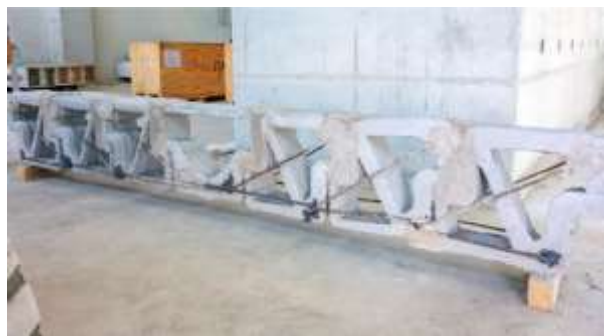
Σχήμα 4-3: Η πρώτη τρισδιάστατη τυπωμένη αρθρωτή δοκός από σκυρόδεμα μήκους περίπου 3 m (WASP, 2017).
