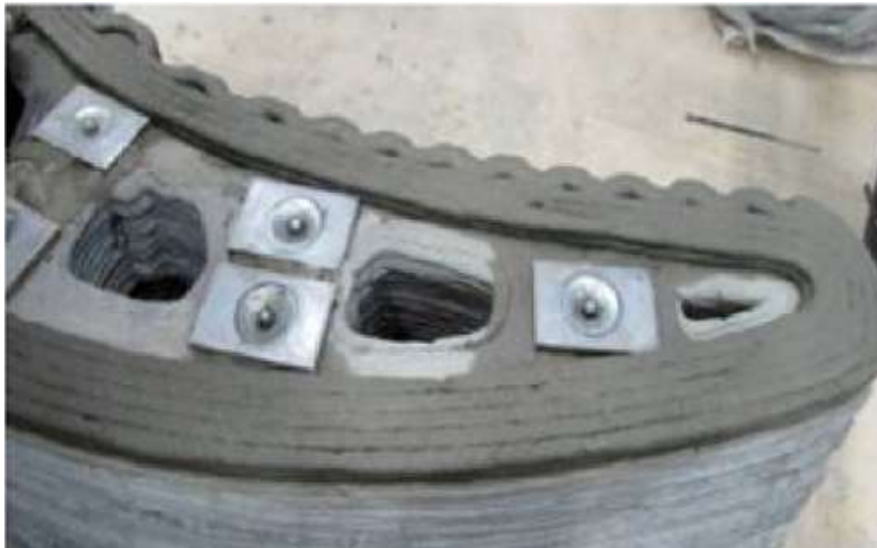
Σχήμα 4-11: Σύστημα ενισχυτικής αγκύρωσης εκτυπωμένου σκυροδέματος
