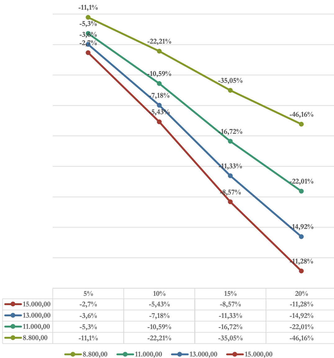
Διάγραμμα 21: Μεταβολή κερδοφορίας σχεδίου Δ σε σχέση με την αύξηση του κόστους, περιεκτικότητα Ni=0,93%
