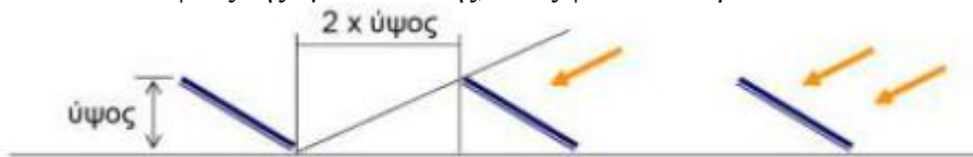
Εικόνα 15: Χωροθέτηση σειρών πάνελ
