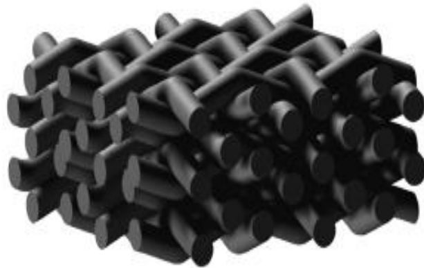
Σχήμα 1.7: Μοντελοποιημένη γεωμετρία της μήτρας συρμάτινου πλέγματος.[7]
