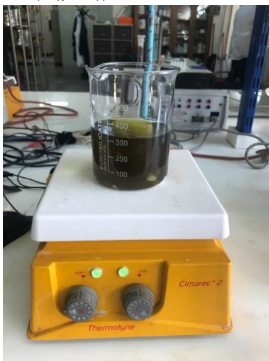
Εικόνα 3.2. Προετοιμασία του μέσου εκχύλισης (διάλυμα Na 2 S και NaOH) σε ποτήρι ζέσεως, με μαγνητική ανάδευση και ταυτόχρονη θέρμανση
