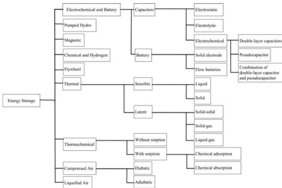
Σχήμα 3.1: Κατηγοριοποίηση εφαρμογών αποθήκευσης ενέργειας [3.2]
