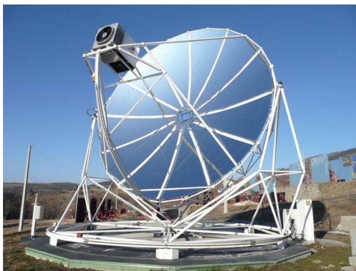
Σχήμα 2.18: Εγκατάσταση Eurodish με συλλέκτη τύπου Dish με μηχανή Stirling [2.20]
