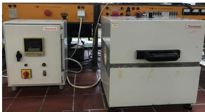
Εικόνα 7.8: Φούρνος υψηλών θερμοκρασιών.
