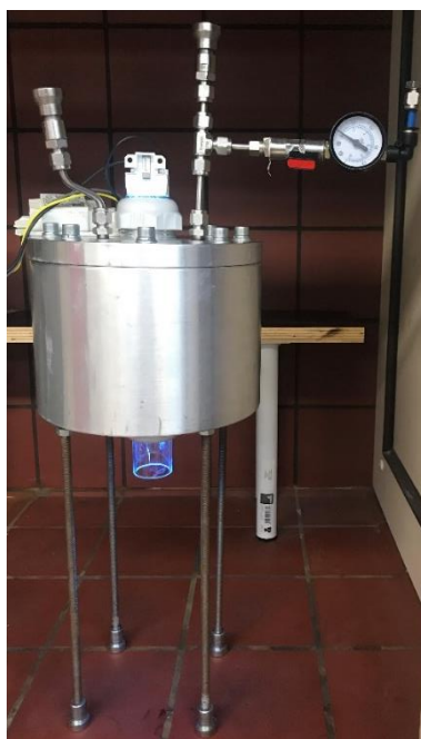
Εικόνα 8.12: Τοποθετημένος ο λαμπτήρας UV-A στον αντιδραστήρα.
