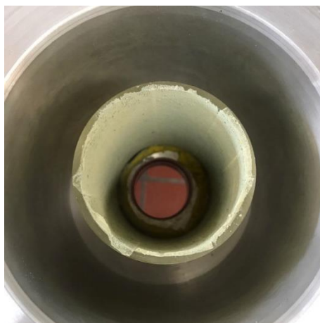
Εικόνα 8.8: Δείγμα Cu/TiO 2 στο θάλαμο του αντιδραστήρα.
