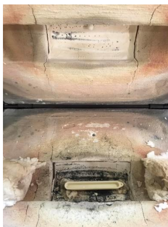
Εικόνα 7.9: Ο Θάλαμος του φούρνου υψηλών θερμοκρασιών.
