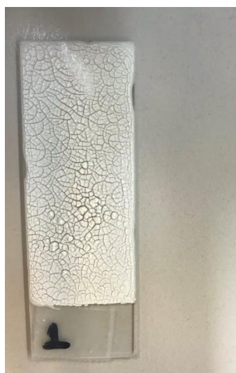
Εικόνα 8.2: Ύαλοι μικροσκοπίου επικαλυμμένο με PVA-TiO 2 .
