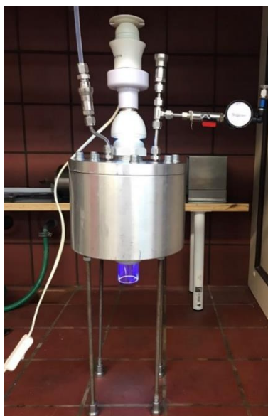
Εικόνα 8.16: Τοποθέτηση λαμπτήρα UV-C 60W στον αντιδραστήρα.
