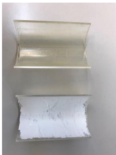
Εικόνα 8.3: Κυλινδρικά κομμάτια χαλαζία με ταινία διπλής όψης και σκόνη TiO 2 .
