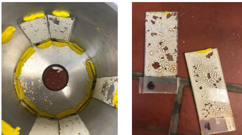
Εικόνα 9.1: Τα δείγματα \text{TiO}_2 με PVA στο θάλαμο του αντιδραστήρα μετά από ακτινοβολήση με UV-A λαμπάκια.
