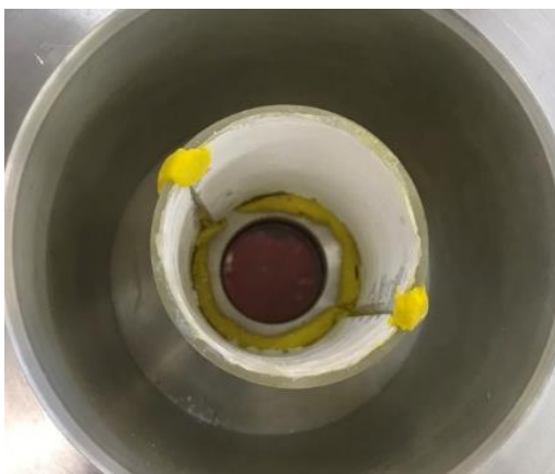
Εικόνα 8.6: Τοποθέτηση δείγματος στο εσωτερικό του αντιδραστήρα σε κοντινή απόσταση από την ακτινοβολία.
