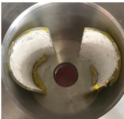
Εικόνα 8.7: Τοποθέτηση δειγμάτων στις πλευρές του θάλαμο.
