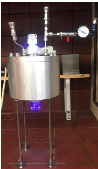
Εικόνα 8.14: Τοποθετημένος ο λαμπτήρας UV-C στον αντιδραστήρα.
