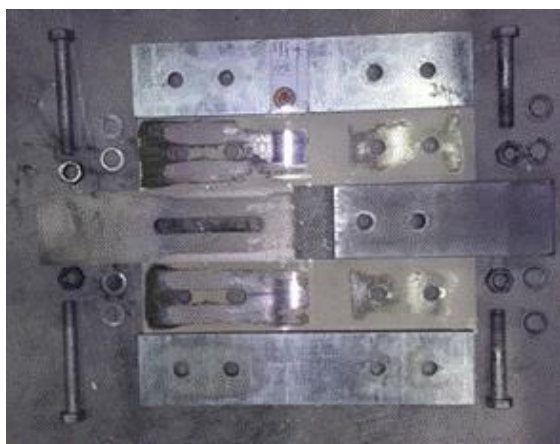
Σχήμα 2.38 : Βλάβη των σφηνών M1
