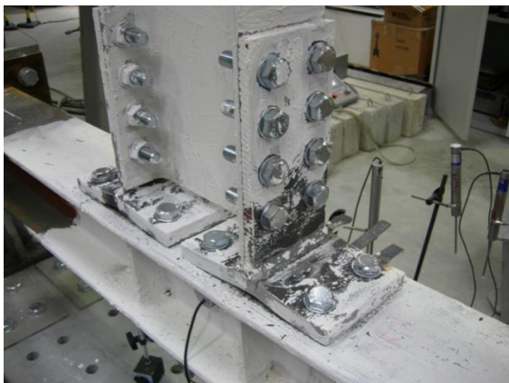
Σχήμα 1.5: Ανακυκλική απόκριση ροπής-στροφής μιας σύνδεσης DST, σχεδιασμένης με τα βραχέα T ως το πιο αδύναμο μέρος της σύνδεσης [25]
