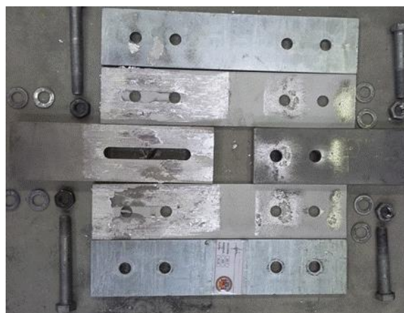
Σχήμα 2.39 : Βλάβη των σφηνών M4
