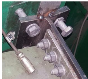
Σχήμα 5.13 : Σύνδεση μετά την αστοχία: συνδετικό T
