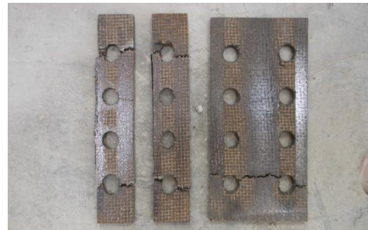
Σχήμα 2.15 : Ψαθυρή αστοχία ελαστομερής σφήνας τριβής στην καθαρή διατομή [43]
