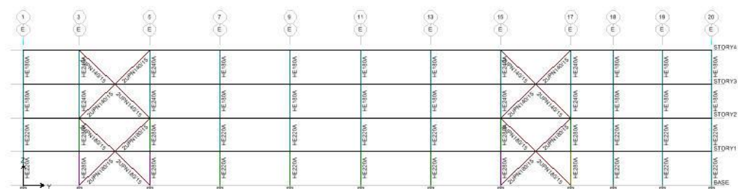
Εικόνα 64: Ομοιομορφοποιημένες διατομές στοιχείων τομής E
