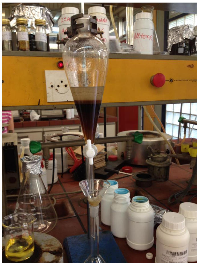
Φωτογραφία 5. Εκχύλιση δείγματος (Αργού Πετρελαίου)
