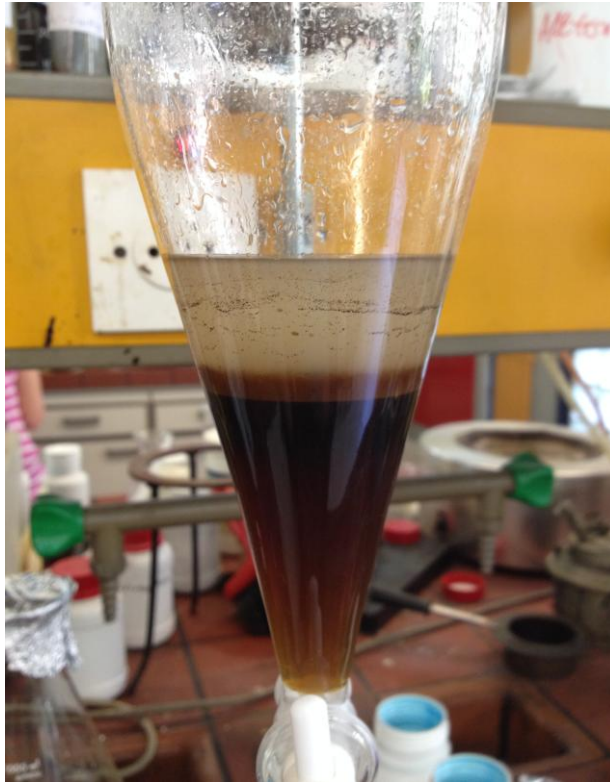
Φωτογραφία 2. Τριαδικό Μίγμα Νερού-Χλωροφορμίου-Αργού Πετρελαίου
