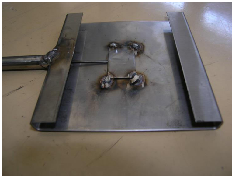
Σχήμα 4.4 Επίπεδο θερμοστοιχείο κατά τη διάρκεια συναρμολόγησής του.
