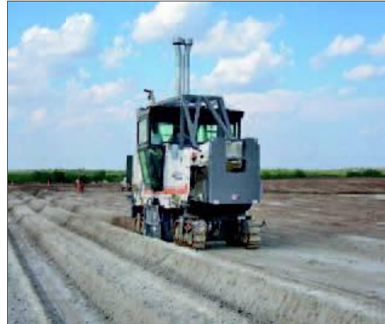
Σχήμα 6.9. Εναπόθεση του υλικού είτε α) πλευρικά είτε β) μπροστά του μηχανήματος εξόρυξης χωρίς χρήση φορτωτή.
