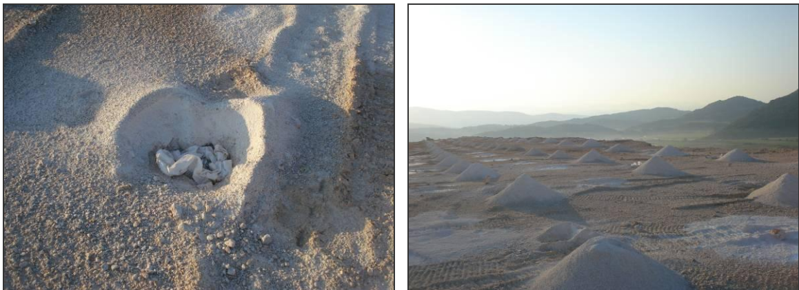
Σχήμα 3.5. α) Προστασία διατρήματος μετά την όρυξη του β) Διάταξη διατρημάτων πριν την εξόρυξη
