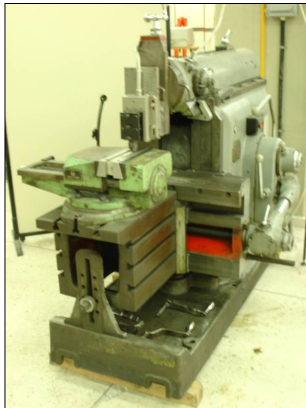
Σχήμα 7.4. Οριζόντια μηχανική ταχυπλάνη Εργαστηρίου Εξόρυξης Πετρωμάτων Ε.Μ.Π.
