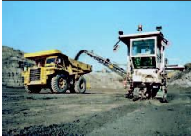
Σχήμα 6.8. Φόρτωση του εξορυγμένου υλικού πλευρικά του μηχανήματος κοπής.
