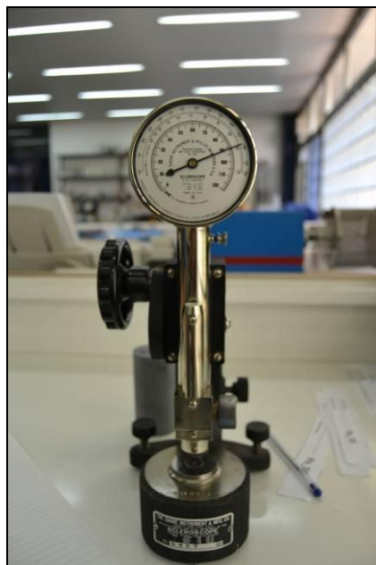
Σχήμα 8.21. Συσκευή shore στο εργαστήριο εξόρυξης πετρωμάτων.
