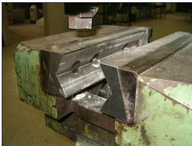
Σχήμα 7.9. Σιαγωνωτή μέγγενη ειδικά σχεδιασμένη για τη συγκράτηση κυλινδρικών δοκιμίων (Αναγνώστου 2006).
