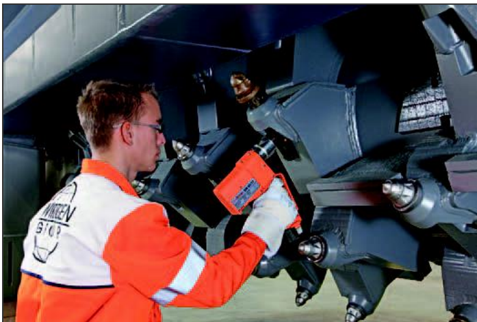
Σχήμα 6.5. Απεικόνιση των κοπτικών εργαλείων και του κοπτικού τύμπανου.
