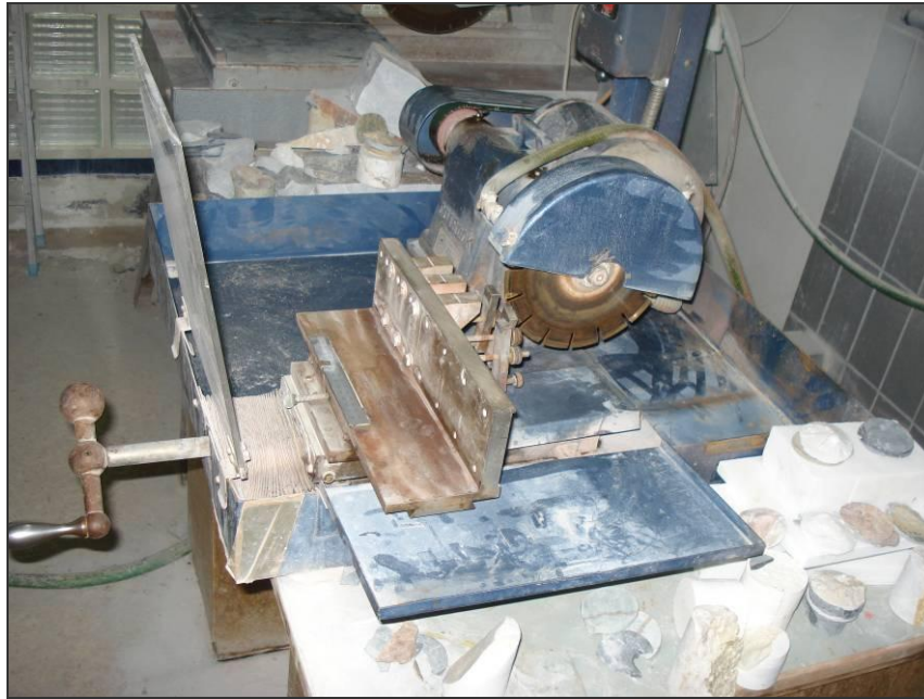
Σχήμα 8.3. Τροχός κοπής για τη διαμόρφωση των δοκιμίων.
