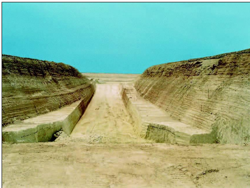
Σχήμα 6.2. Εξόρυξη ασβεστολίθου σε βαθμίδες και δυνατότητα δημιουργίας τάφρων.
