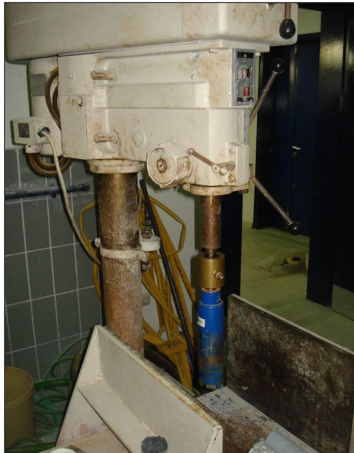
Σχήμα 8.1. Καροταρία εργαστηρίου για τη λήψη δοκιμίων.
