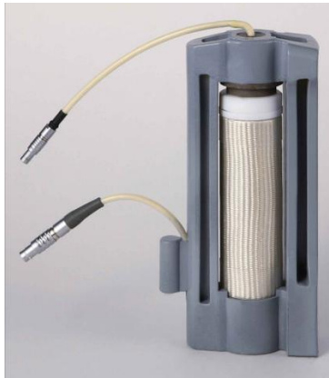
Εικόνα 2.2.10: Αντιδραστήρας μικροκυμάτων με ενσωματωμένους αισθητήρες πίεσης και θερμοκρασίας. 42
