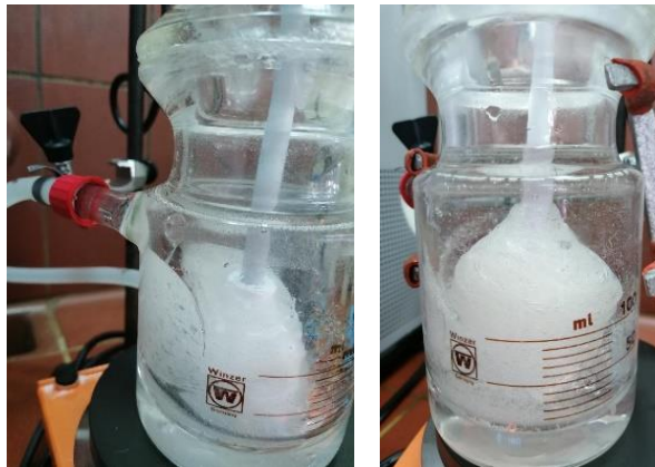
Εικόνα 5.4.4: Συμπεριφορά αντιδρώντος μίγματος στην αύξηση του ιξώδους.
