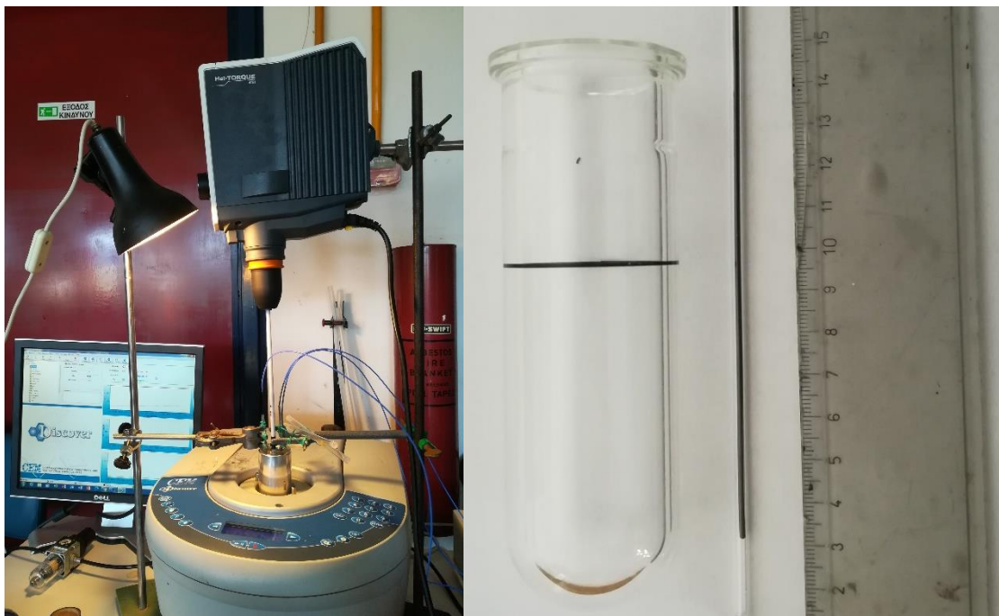
Εικόνα 3.4.1: Πειραματική διάταξη μικροκυμάτων σε συνθήκες ανοιχτού δοχείου (αριστερά) και αντιδραστήρας (δεξιά).
