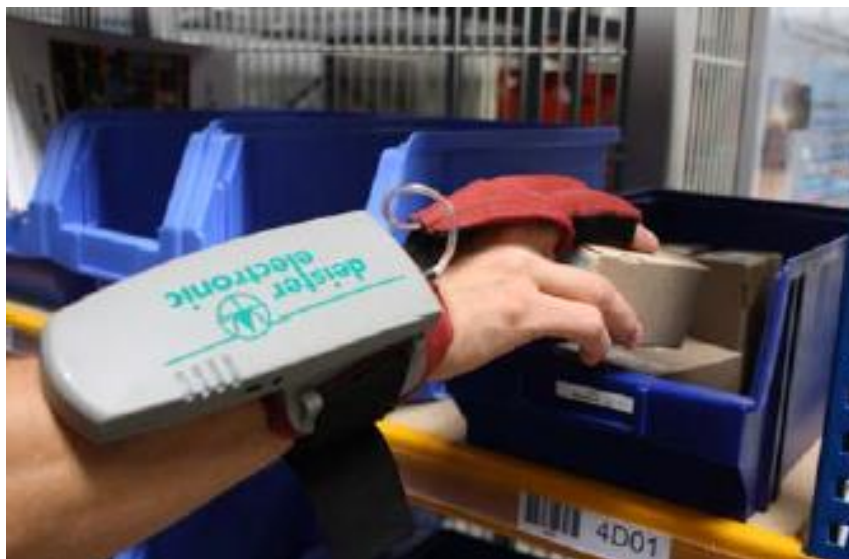
Εικόνα 4: Συλλογή με τη χρήση γαντιού RFID (Rammelmeier et al., 2011)
