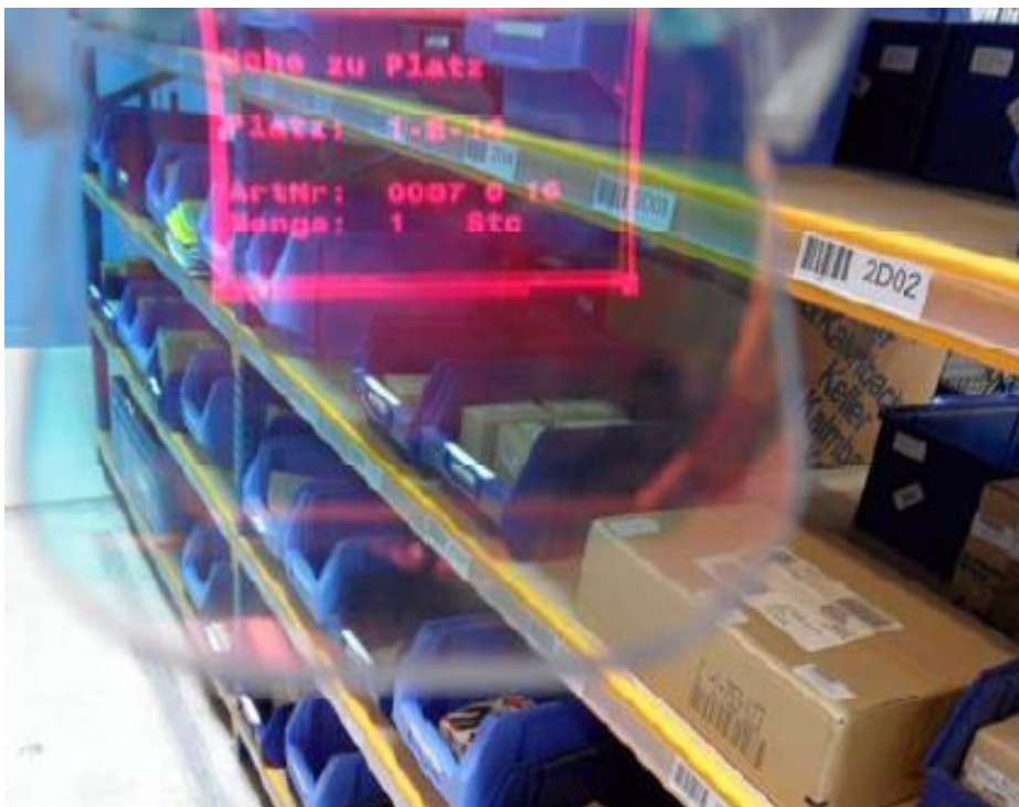
Εικόνα 1: : Σύστημα Pick-by-Vision χωρίς ενσωματωμένη δυνατότητα παρακολούθησης (Rammelmeier et al., 2011)
