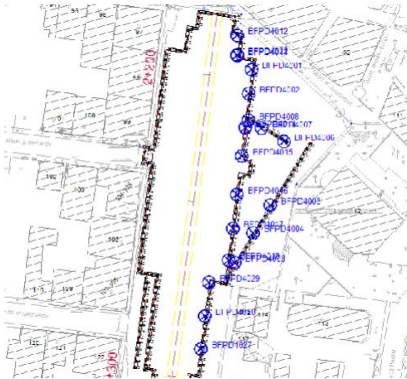
Εικόνα 5.3 Οριζοντιογραφία θέσεων δεύτερης ομάδας τρισδιάστατων στόχων, του σταθμού Αγ. Βαρβάρας, (πηγή: Αρχείο Γ.Δ.Π. του Ανάδοχου).
