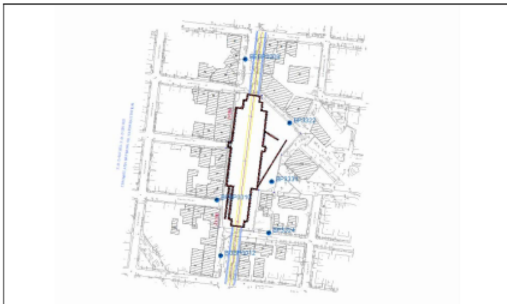
Διάγραμμα 5.29 Διάγραμμα ενδείξεων στάθμης υπόγειου νερού πιεζόμετρων (απόλυτα υψόμετρα σε m) σε σχέση με την εξέλιξη των εργασιών εκσκαφής και οριζοντιογραφία απεικόνισης των θέσεων τους, του σταθμού Αγ. Βαρβάρας, (πηγή: Αρχείο Γ.Δ.Π. του Ανάδοχου).
