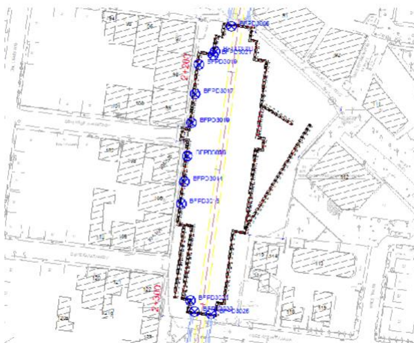
Εικόνα 5.6 Οριζοντιογραφία θέσεων πέμπτης ομάδας τρισδιάστατων στόχων, του σταθμού Αγ. Βαρβάρας, (πηγή: Αρχείο Γ.Δ.Π. του Ανάδοχου).
