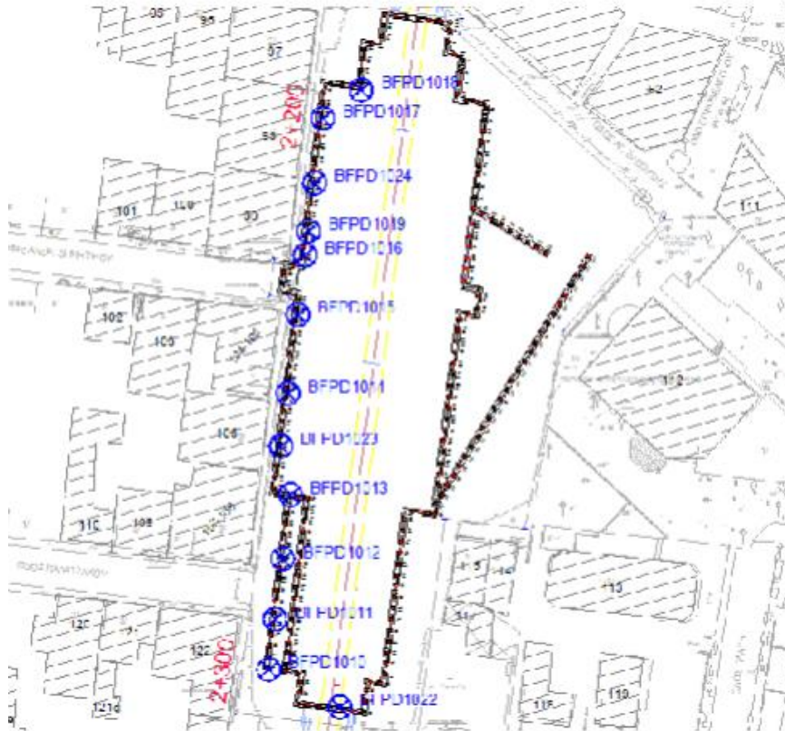
Εικόνα 5.10 Οριζοντιογραφία θέσεων ένατης ομάδας τρισδιάστατων στόχων, του σταθμού Αγ. Βαρβάρας, (πηγή: Αρχείο Γ.Δ.Π. του Ανάδοχου).
