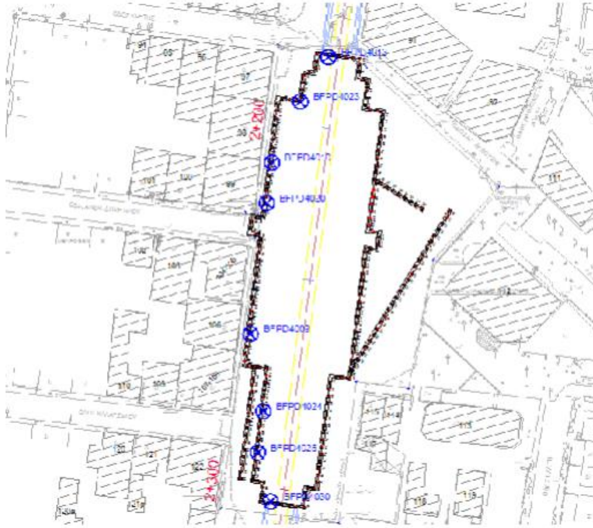
Εικόνα 5.4 Οριζοντιογραφία θέσεων τρίτης ομάδας τρισδιάστατων στόχων, του σταθμού Αγ. Βαρβάρας, (πηγή: Αρχείο Γ.Δ.Π. του Ανάδοχου).
