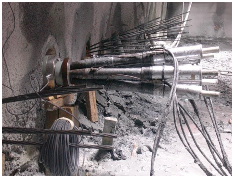
Εικόνα 3.2 Φωτογραφική τεκμηρίωση κυψέλης φορτίου σε προεντεταμένο αγκύριο (πηγή: Αρχείο Γ.Δ.Π. του Ανάδοχου).
