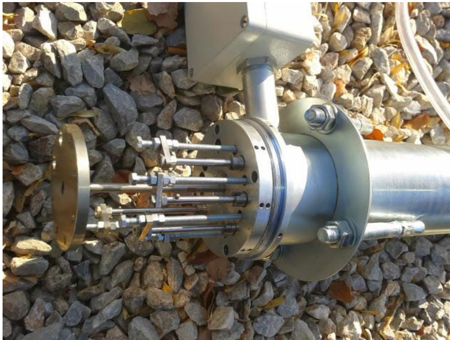
Εικόνα 3.1 Φωτογραφική τεκμηρίωση εκτασιόμετρου ράβδων του Σταθμού Αγίας Βαρβάρας (πηγή: Αρχείο Γ.Δ.Π. του Ανάδοχου).
