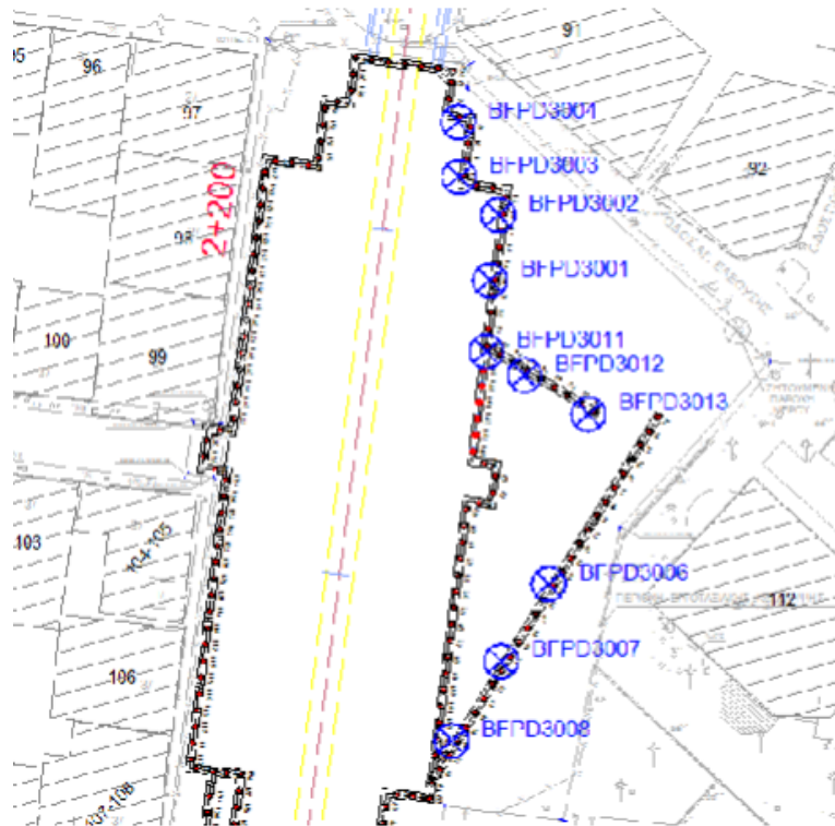
Εικόνα 5.5 Οριζοντιογραφία θέσεων τέταρτης ομάδας τρισδιάστατων στόχων, του σταθμού Αγ. Βαρβάρας, (πηγή: Αρχείο Γ.Δ.Π. του Ανάδοχου).
