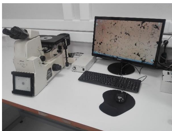
Σχήμα 17. Ανάστροφο Οπτικό Μικροσκόπιο Nikon Epihot 300.
