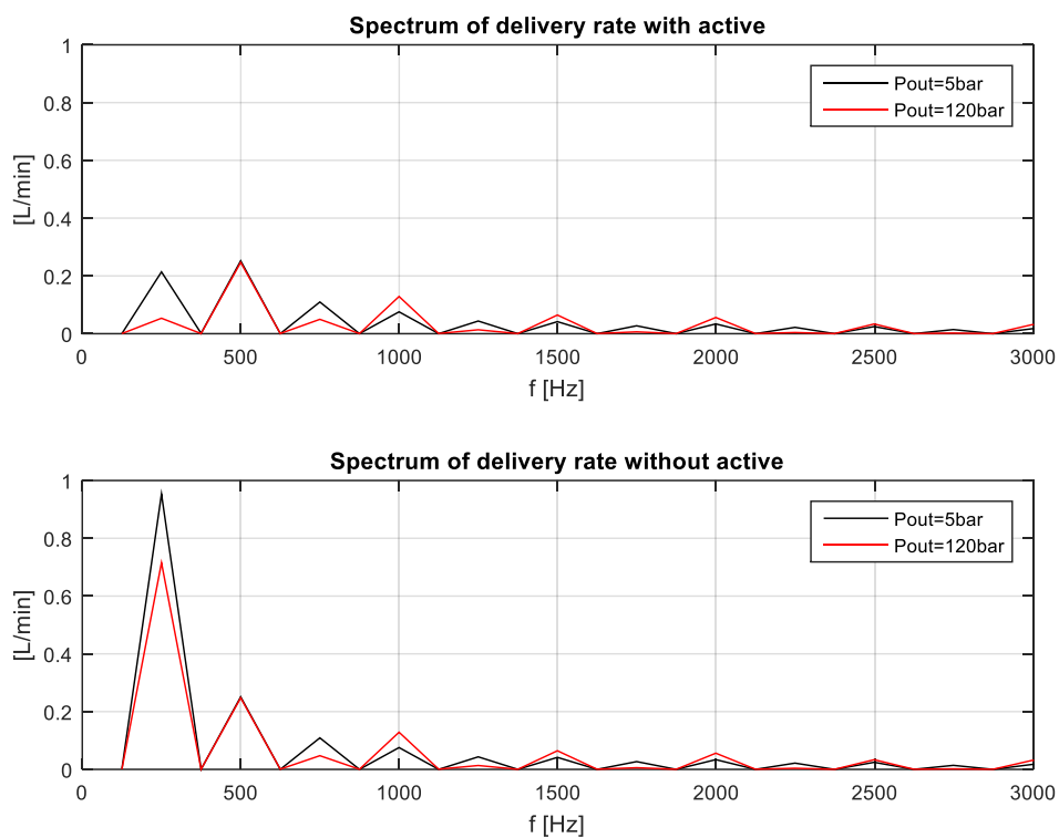
Διάγραμμα 32 - Ο μετασχηματισμός FFT της παροχής στην έξοδο του συστήματος με και χωρίς τη λειτουργία του ενεργητικού συστήματος για την ελάχιστη και μέγιστη πίεση λειτουργίας
