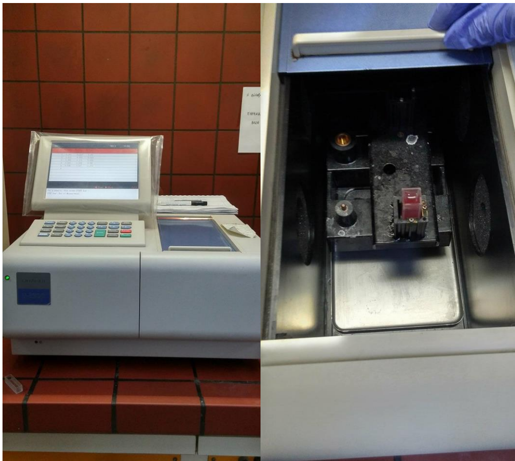
Εικόνα 7 & Εικόνα 8: Η εξωτερική και εσωτερική όψη του φωτόμετρου
