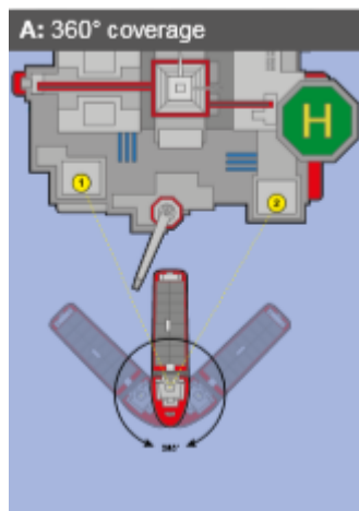
Διάγραμμα 1.3: Τρόπος λειτουργίας του RadaScan-View (Guidance Marine, 2021).
