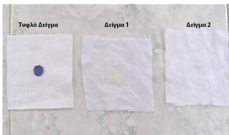
Εικόνα 2.4 Ικανότητα αφαίρεσης λεκέδων της ενδογλουκανάσης. Το μεσαίο δείγμα (Sample 1) επεξεργάστηκε με απορρυπαντικό διάλυμα, ενώ το δεξί δείγμα (Sample 2) με απορρυπαντικό διάλυμα με προσθήκη καθαρής ενδογλουκανάσης παρουσίασε παντελής αφαίρεση του λεκέ από μελάνι, σε σχέση με το τυφλό δείγμα (Control) (Τροποποίηση από [76]).
