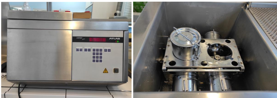
Εικόνα 3.3 Συσκευή Linitest plus για τη διεξαγωγή πολλαπλών πλύσεων μικρού όγκου.
