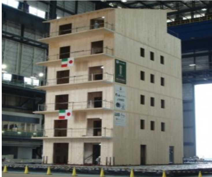
Εικόνα 4.4 Δοκιμή σε σεισμό 7όροφου κτιρίου από CLT
