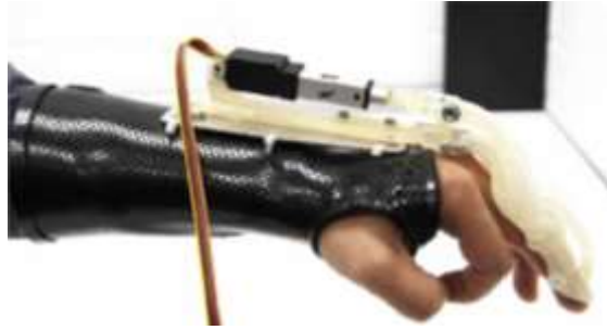
Σχήμα 13: Εξωσκελετικό σύστημα με τρισδιάστατη εκτύπωση (Curtinnovation.com, 2017)
