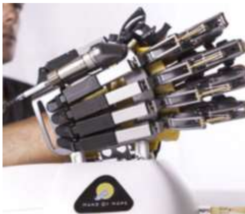
Σχήμα 11: Εξωσκελετικό σύστημα “hand of hope” (Rehab Robotics 2018)
