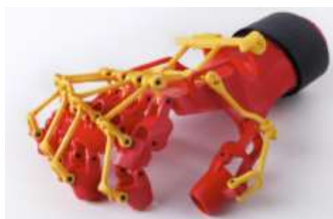
Σχήμα 12: Εξωσκελετικό σύστημα με τρισδιάστατη εκτύπωση (ZMorph Blog, 2018)
