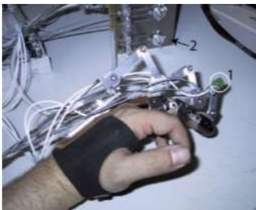
Σχήμα 7: Μοντέλο αποκατάστασης A. Wege, K. Kondak, and G. Hommel. 1 : Αισθητήρας Hall, 2 : Ενεργοποιητής
