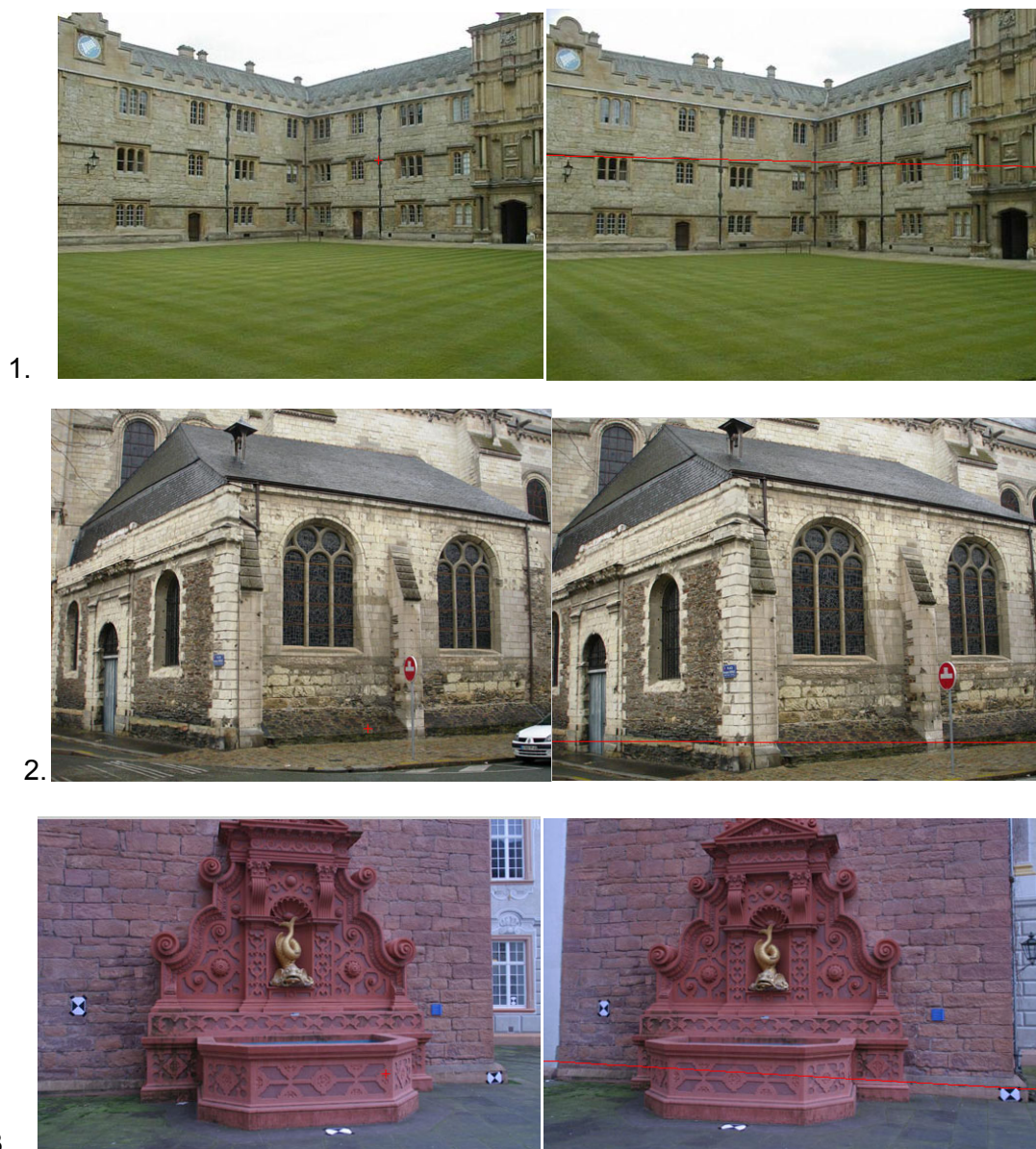
Σχήμα 7.10: Ομόλογη επιπολική γραμμή σημείου.
