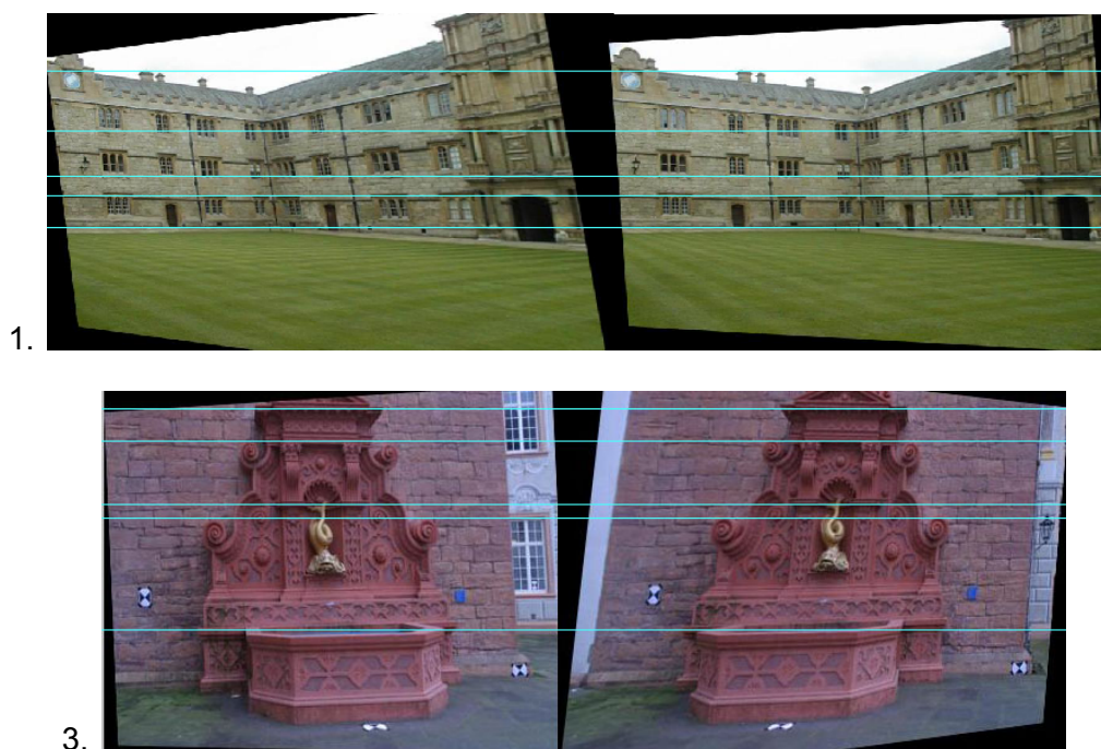
Σχήμα 7.14α: Επιπολικές γραμμές σε επιπολικές εικόνες μη βαθμονομημένων στερεοζευγών.
