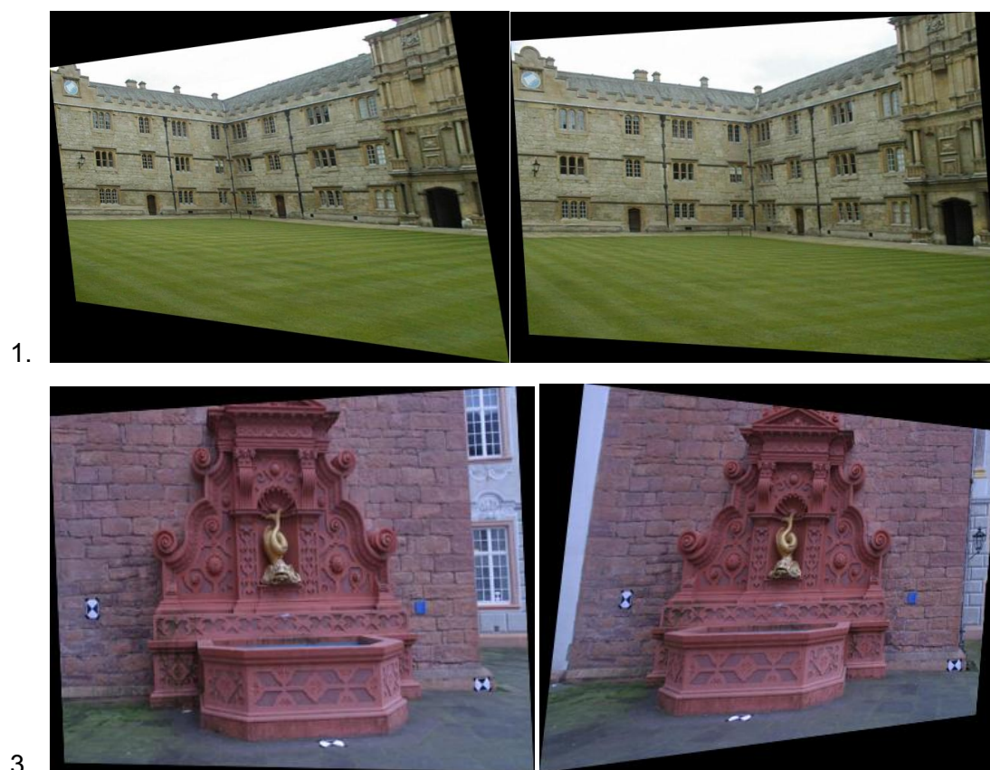
Σχήμα 7.13: Επιπολικές εικόνες μη βαθμονομημένων στερεοζευγών.
