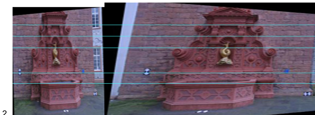
Σχήμα 7.14γ: Επιπολικές γραμμές σε επιπολικές εικόνες μη βαθμονομημένου στερεοζεύγους.
