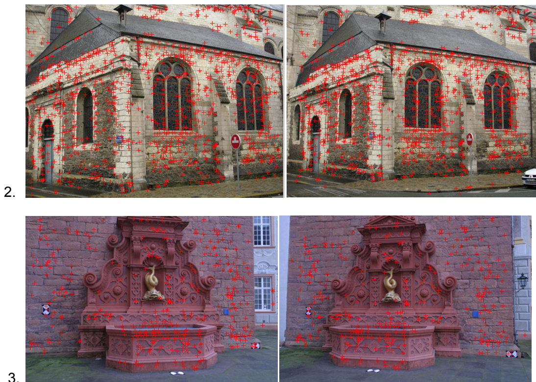
Σχήμα 7.4: Εύρεση ομολογιών με βάση την ευκλείδεια απόσταση των περιγραφέντων.
