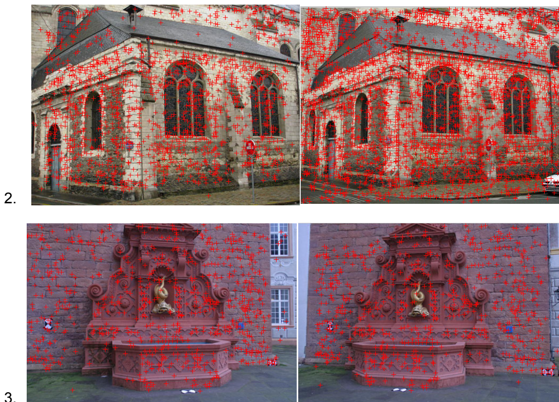
Σχήμα 7.3: Αρχική αντιστοίχιση ομολογιών SIFT.
