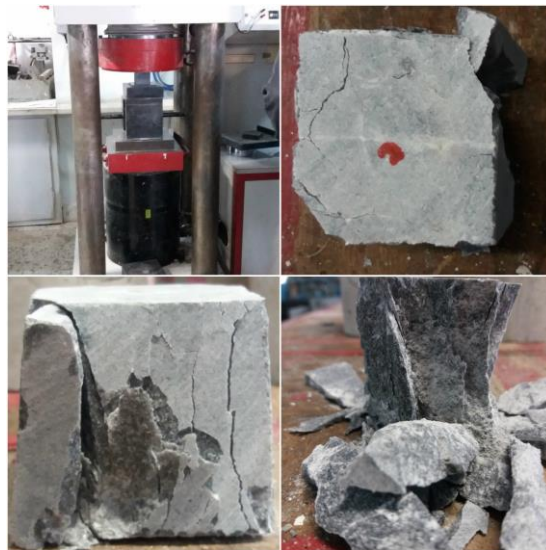
Εικόνα 46. Οι λίθοι που χρησιμοποιήθηκαν στους τοιχίσκους στην μηχανή θλίψης και μετά την δοκιμή τους
