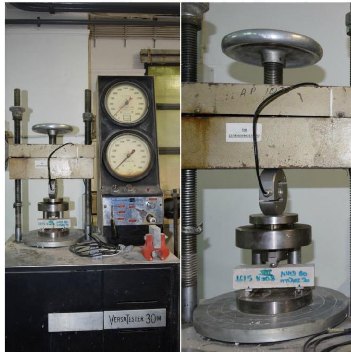
Εικόνα 29. Φωτογραφία κατά την διάρκεια της δοκιμής για την αποτίμηση της καμπτικής αντοχής δοκιμίων ενεμάτων και κονιαμάτων
