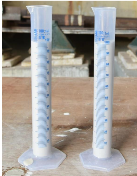
Εικόνα 33. Φωτογραφία ογκομετρικών κυλίνδρων 100ml που χρησιμοποιούνται στην μέτρηση της εξίδρωσης
