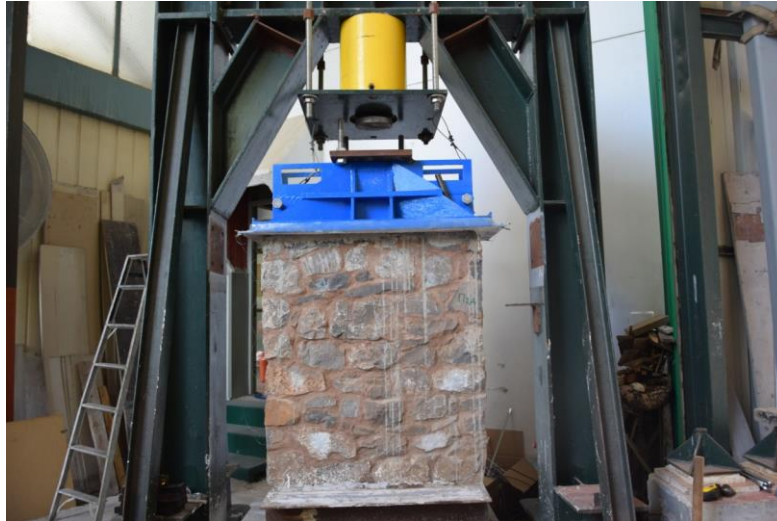
Εικόνα 47. Φωτογραφία διάταξης που αποτιμά την θλιπτική αντοχή των τοιχίσκων
