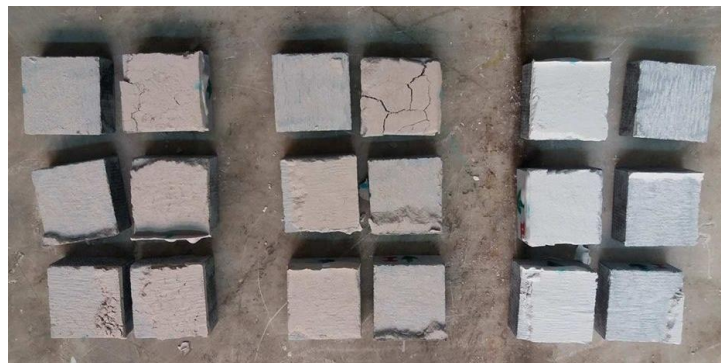
Εικόνα 92. Τρόπος αστοχίας των σύνθετων δοκιμίων των διεπιφανειών για \sigma_n = 0,3\text{MPa} και 90 ημέρες ωρίμανσης NHL 5: 63% Poz: 7% Clay: 30%(μεσαία), NHL 5: 70% Clay: 30%(αριστερά), NHL 5: 100%(δεξιά)
