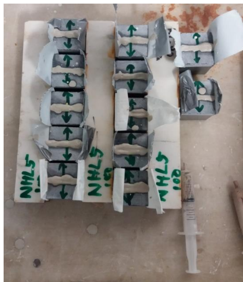
Εικόνα 35. Υλοποίηση του παραπάνω προτύπου καθώς και διατήρηση της ορθογωνικότητας και επιπεδότητας μέσω των δύσκαμπτων οδηγών εκατέρωθεν των σύνθετων δοκιμίων
