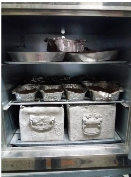
Εικόνα 28. Ξήρανση του πηλού για να μπορέσει να πραγματοποιηθεί το κοσκίνισμα του
