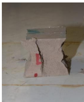
Εικόνα 71. Τυπική μορφή θλιπτικής αστοχίας δοκιμίου ενέματος
