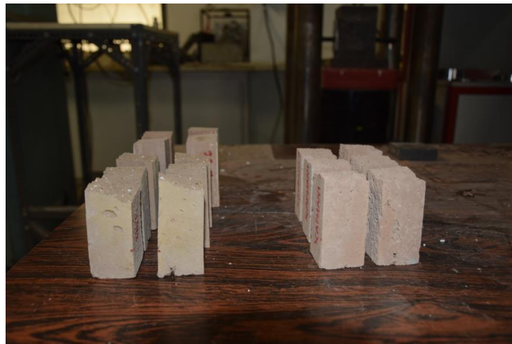
Εικόνα 50. Τυπική μορφή καμπτικής αστοχίας δοκιμίων πηλοκονιαμάτων (πάνω) και πηλοασβεστοκονιαμάτων (μεσαίο)
