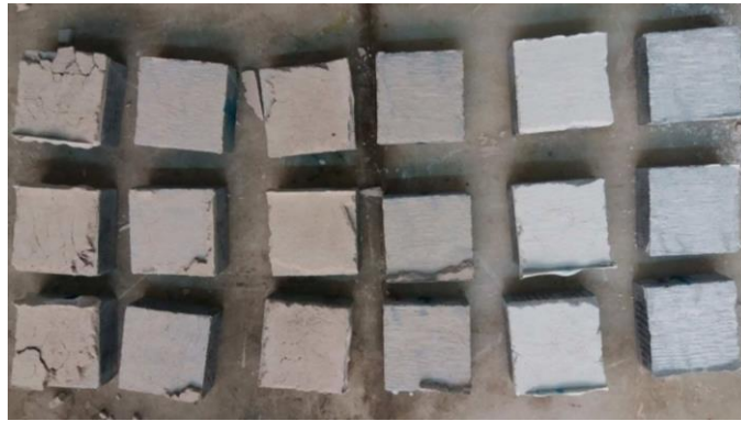
Εικόνα 91. Τρόπος αστοχίας των σύνθετων δοκιμίων των διεπιφανειών για \sigma_n = 0,1\text{MPa} και 90 ημέρες ωρίμανσης NHL 5: 63% Poz: 7% Clay: 30%(αριστερά), NHL 5: 70% Clay: 30%(μεσαία), NHL 5: 100%(δεξιά)
