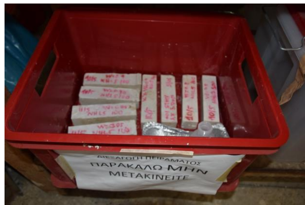
Εικόνα 26. Συντήρηση δοκιμίων ενεμάτων στο αεροστεγές κουτί
