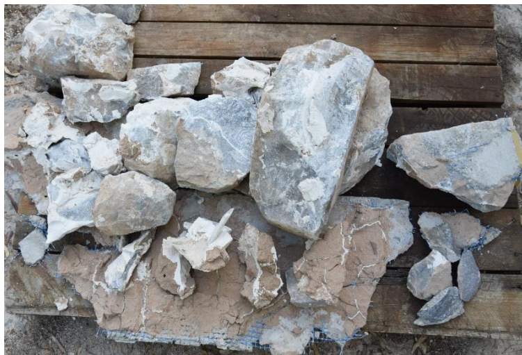
Εικόνα 122. Συνάφεια λίθου-ενέματος-κονιάματος στον τοιχίσκο ΑΠΙ
