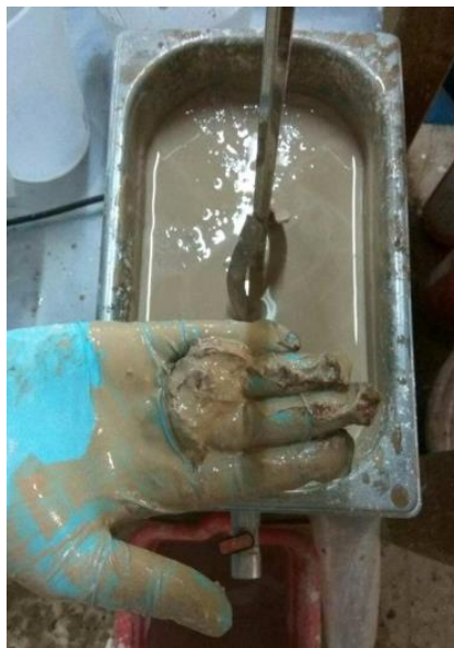
Εικόνα 85. Συσσωματώματα μετά την ανάμιξη των ενεμάτων με την τοποθέτηση του πηλού πρώτα στην ανάμιξη
