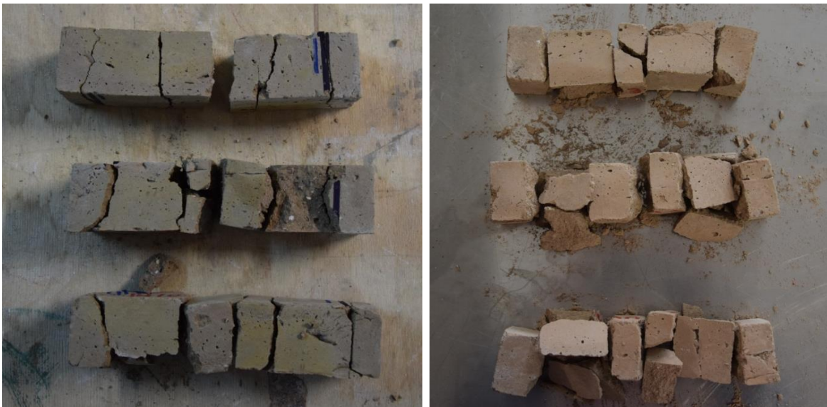
Εικόνα 52. Τυπική μορφή θλιπτικής αστοχίας δοκιμίων πηλοκονιάματος (πάνω) πηλοασβεστοκονιάματος (κάτω)
