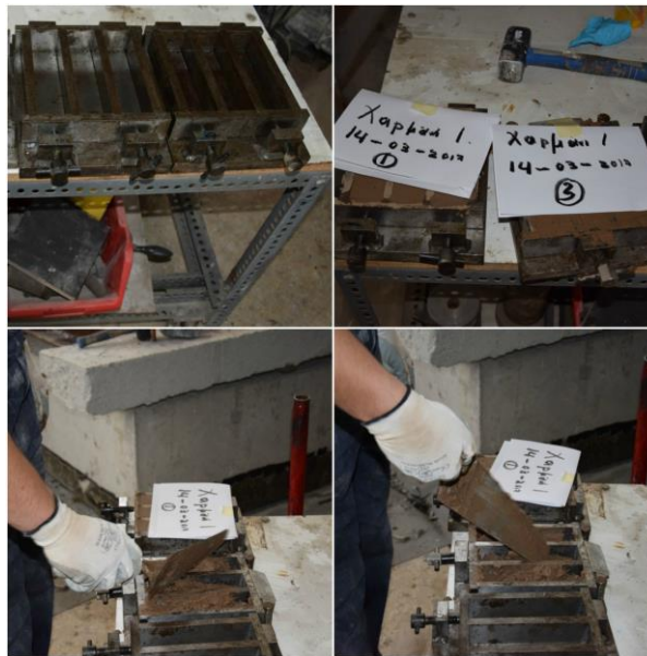
Εικόνα 22. Μήτρες συντήρησης δοκιμών κονιάματος από τυχαία χαρμάνια, καθώς και διαμόρφωσή (με σπάτουλα) της τελικής τους επιφάνειας
