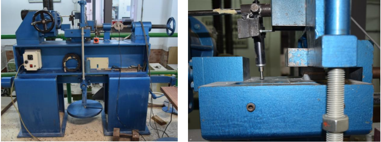
Εικόνα 39. Μηχανή στην οποία γίνεται η δοκιμή της διάτμησης των σύνθετων δοκιμίων διεπιφανειών (αριστερά) και δοκίμιο κατά την διάρκεια της δοκιμής της διάτμησης (δεξιά)
