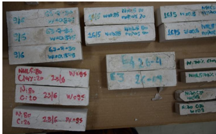
Εικόνα 27. Φωτογραφία ρηγματωμένων δοκιμίων ενεμάτων με τον τρόπο συντήρησης II
