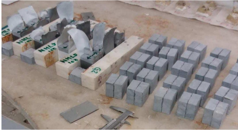
Εικόνα 34. Προετοιμασία σύνθετων δοκιμίων διεπιφανειών υποβάθρου ενέματος για πλήρωσης του αρμού
