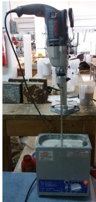
Εικόνα 23. Συσκευή υπερήχων κατά την διάρκεια ανάδευσης σύνθεσης ενέματος
