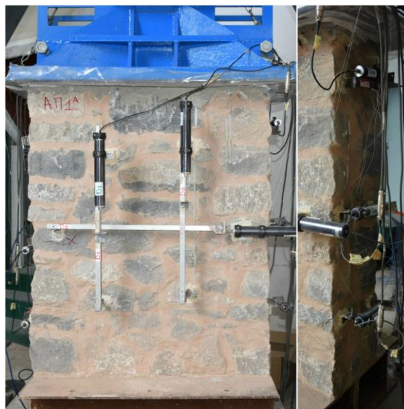
Εικόνα 48. Θέσεις οργάνων στην μπροστινή και στην πλάγια όψη των τοιχίσκων
