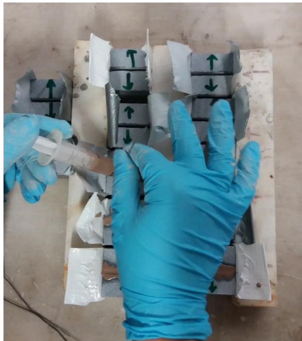
Εικόνα 37. Έγχυση του ενέματος με σύριγγα, καθώς και τρόπος με τον οποίο διατηρείται ο άδειος αρμός σε σταθερό πλάτος (καλούπι)
