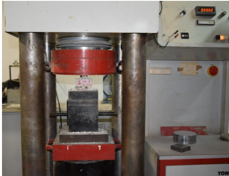
Εικόνα 30. Μηχανή θλίψης κατά την διάρκεια της δοκιμής
