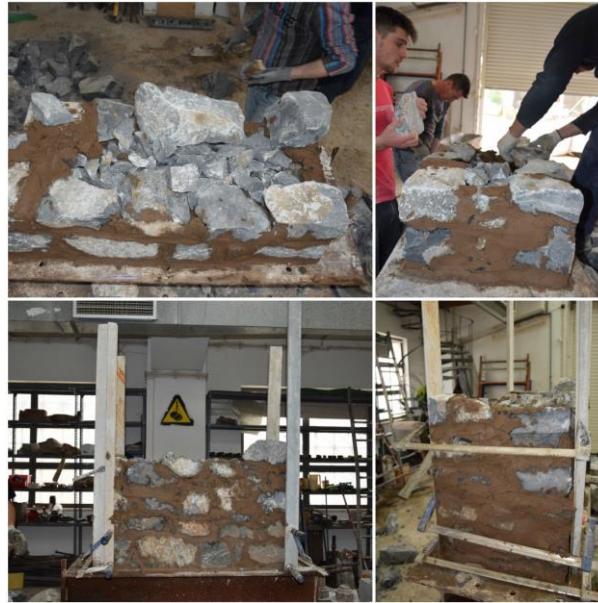
Εικόνα 45. Φωτογραφίες από την κατασκευή σε στάδια των τρίστρωτων τοιχίσκων
