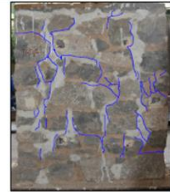
ΤΑΠ1- Τρίστρωτος με πηλοασβεστοκονίαμα
