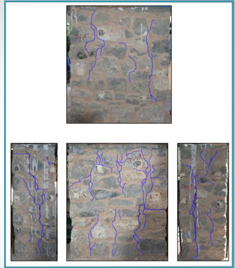
ΤΑΠ1- Τρίστρωτος με πηλοασβεστοκονίαμα
