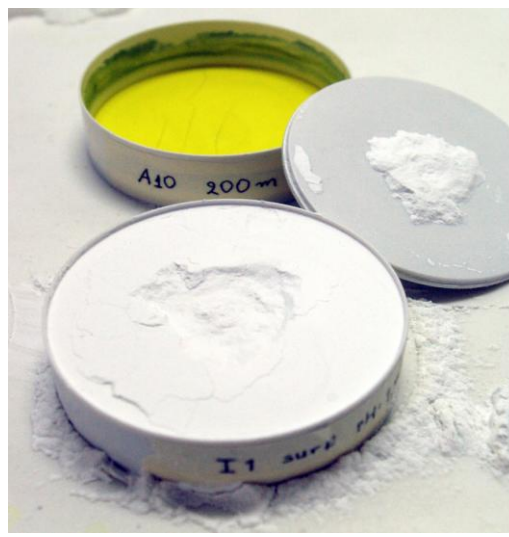
Εικόνα 3.11 (αριστερά): Το 1ml ^{134}\text{Cs} που χρησιμοποιούμε ως έλεγχο για τη χημική απόδοση της μεθόδου μας.
