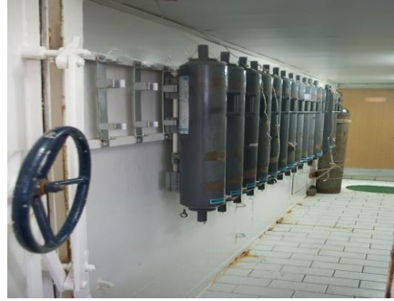
Εικόνα 3.4: Δοχεία Niskin τα οποία τοποθετήθηκαν πάνω στη ροζέτα
