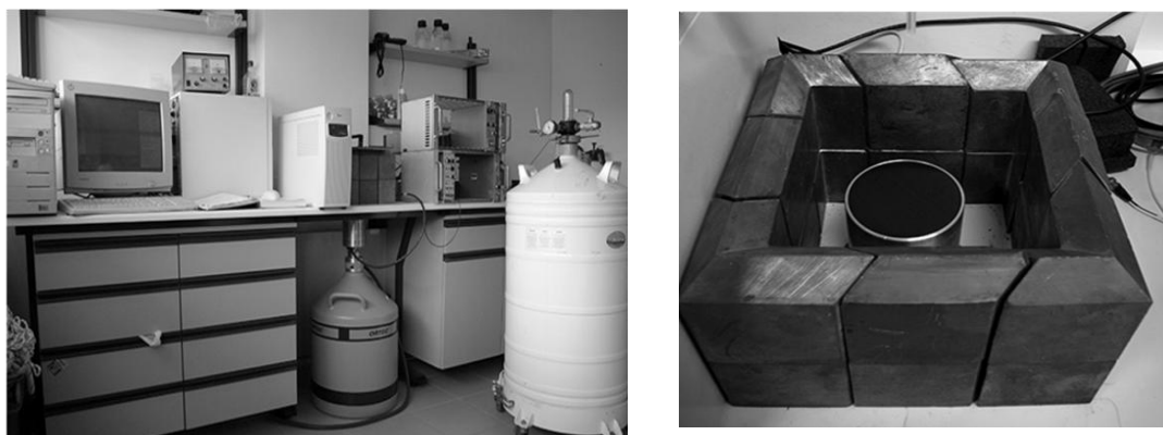
Εικόνα 4.1: Η πειραματική ανιχνευτική συσκευή HPGe του ΕΛ.ΚΕ.Θ.Ε. (αριστερά), στην οποία μετρήθηκαν τα δείγματα της πρώτης περιόδου (Απρίλιος 2008). Στη δεξιά εικόνα φαίνεται η κατακόρυφη θωράκιση του ανιχνευτή.
