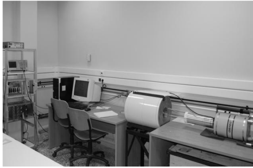
Εικόνα 4.2: Η πειραματική ανιχνευτική συσκευή HPGe του ΕΜΠ (αριστερά), στην οποία μετρήθηκαν τα δείγματα της πρώτης περιόδου (Αύγουστος 2008). Στη δεξιά εικόνα φαίνεται η κατακόρυφη θωράκιση του ανιχνευτή.
