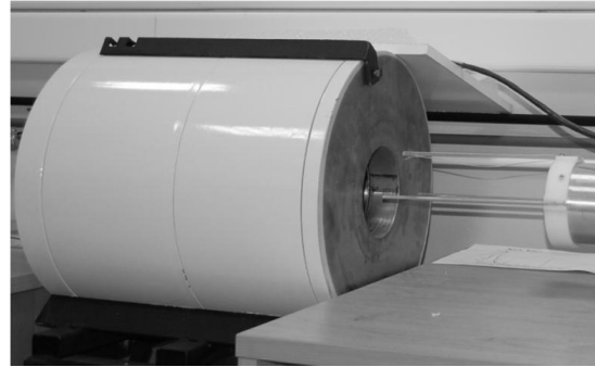
Εικόνα 4.2: Η πειραματική ανιχνευτική συσκευή HPGe του ΕΜΠ (αριστερά), στην οποία μετρήθηκαν τα δείγματα της πρώτης περιόδου (Αύγουστος 2008). Στη δεξιά εικόνα φαίνεται η κατακόρυφη θωράκιση του ανιχνευτή.
