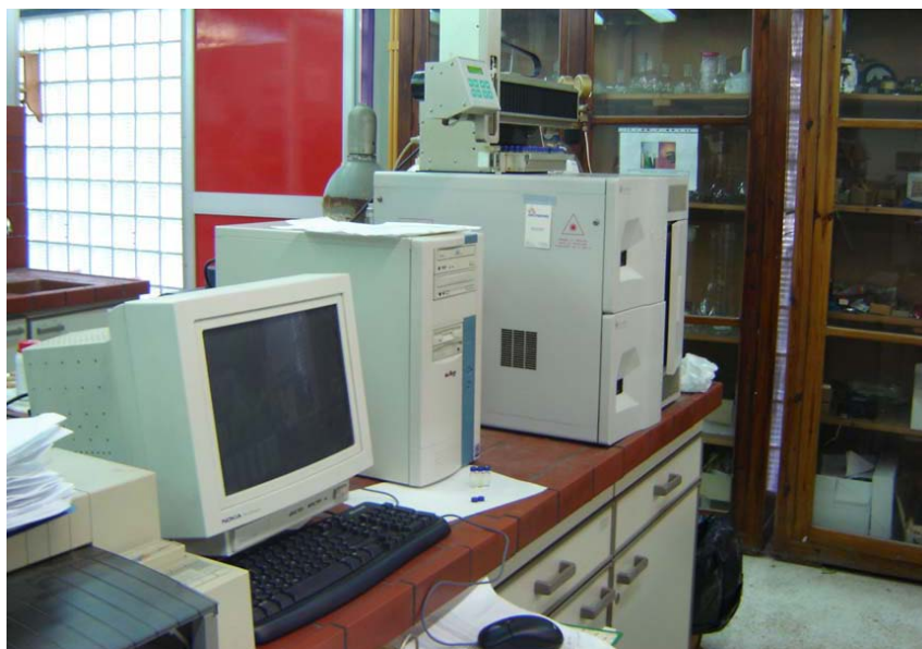
Σχήμα 3.8 Προσδιορισμός περιεκτικότητας σε S με χρήση αναλυτή ANTEK 9000.
