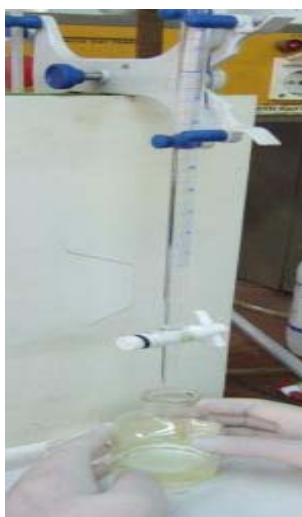
Σχήμα 3.6 Διάταξη τιτλοδότησης για τη μέτρηση του Αριθμού οξύτητας.
