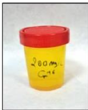
Σχήμα 3-1 : Πρότυπο διάλυμα Cr(VI) συγκέντρωσης 200mg/L.
