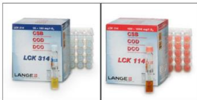
Σχήμα 3-10 : Αντιδραστήρια της HACH για τη μέτρηση του χημικώς απαιτούμενου οξυγόνου (COD). Αριστερά βρίσκονται τα αντιδραστήρια με εύρος συγκεντρώσεων 15-50 \text{mgO}_2/\text{L} και δεξιά αυτά με εύρος 150-1000 \text{mgO}_2/\text{L} .
