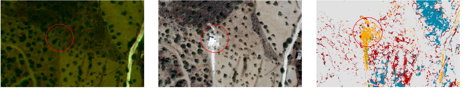
Εικόνα 13: Απόσπασμα αποτελέσματος ταξινόμησης 2 ου dataset, ορθή ανίχνευση νέου κτίσματος, λανθασμένη ταξινόμηση εδάφους ως μεταβολή από έδαφος σε κτίσμα κεραμοσκεπές ή πλακοσκεπές
