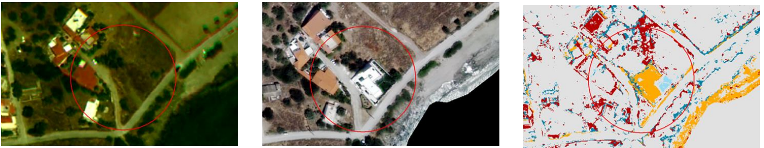
Εικόνα 14: Απόσπασμα αποτελέσματος ταξινόμησης 2 ου dataset, ορθή ανίχνευση νέου κτίσματος και πισίνας
