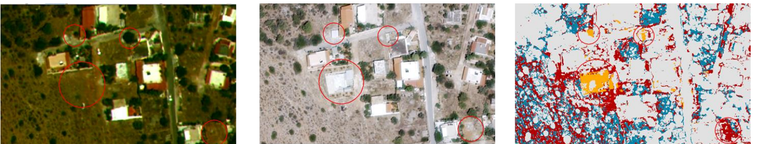
Εικόνα 11: Απόσπασμα αποτελέσματος ταξινόμησης 1 ου dataset, ορθή ανίχνευση νέων κτισμάτων, λανθασμένη ταξινόμηση εδάφους ως μεταβολή σε κτίσμα
