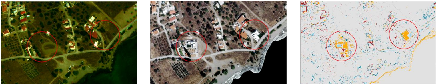
Εικόνα 19: Απόσπασμα αποτελέσματος ταξινόμησης 2ου dataset, ορθή ανίχνευση νέων κτισμάτων
