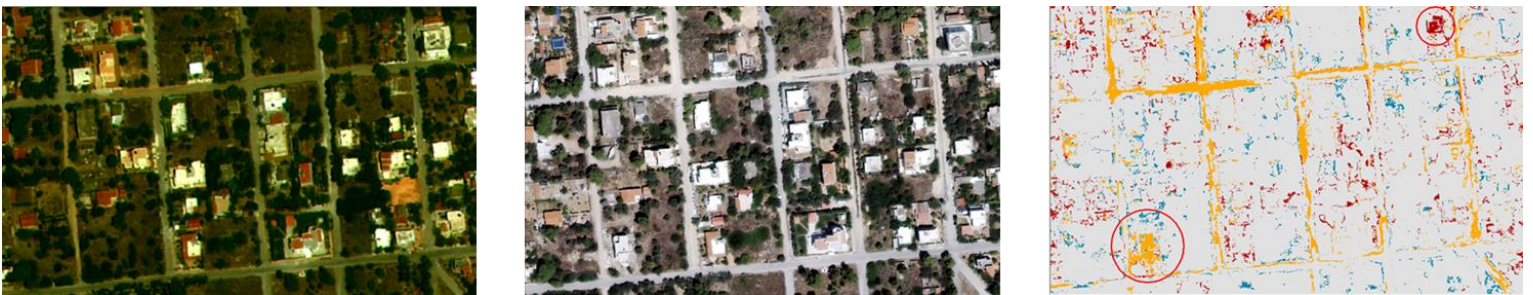
Εικόνα 17: Απόσπασμα αποτελέσματος ταξινόμησης 1 ου dataset, λανθασμένη ταξινόμηση ασφάλτου ως μεταβολή από έδαφος σε κτίσμα πλακοσκεπές
