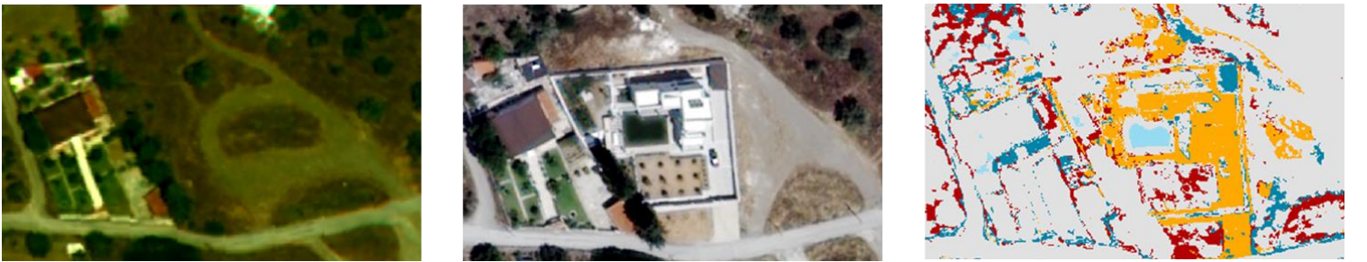
Εικόνα 15: Απόσπασμα αποτελέσματος ταξινόμησης 2 ου dataset, ορθή ανίχνευση νέου κτίσματος και πισίνας
