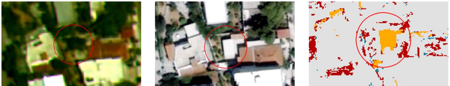
Εικόνα 10: Απόσπασμα αποτελέσματος ταξινόμησης 1 ου dataset, ορθή ανίχνευση νέου κτίσματος: λευκό πλακοσκεπές
