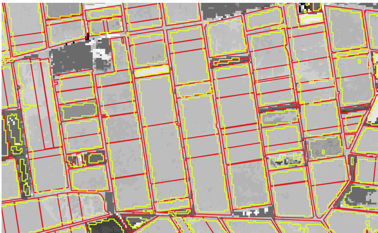
Εικόνα 3.8. Συνεκτικές υπο-περιοχές (κίτρινο) σε διανυσματική μορφή και αρχικά LPIS δεδομένα (κόκκινο) μετά τη διαδικασία επιλογής του Κεφαλαίου 3.2. Το υπόβαθρο αποτελεί φασματοχρονικό χαρακτηριστικό (Temporal Feature) του δείκτη NDVI για την ημερομηνία όπου εμφανίζεται η μέγιστη τιμή NDVI σε κάθε εικονοστοιχείο.
