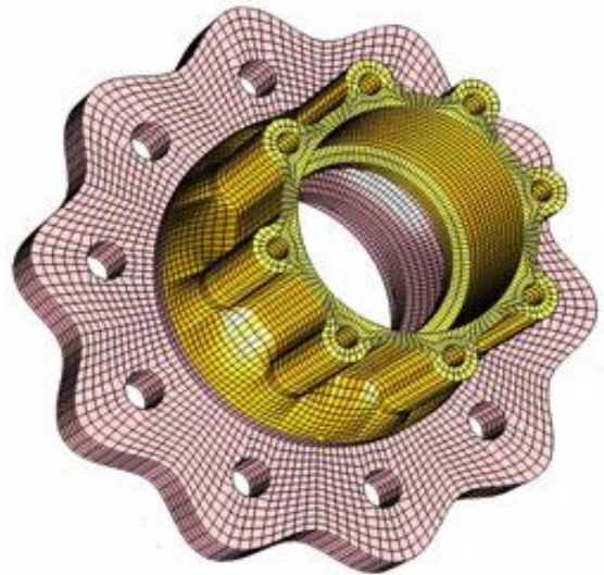
Εικόνα 3.2 : Παράδειγμα διακριτοποίησης και εφαρμογής πλέγματος σε πολύπλοκη κατασκευή [13]
