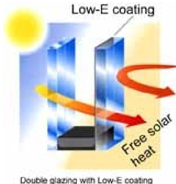
Σχημα 4.6: Απεικονιση θερμικής ροής ακτινοβολίας μέσω καλυματων χαμηλής εκπομπης
