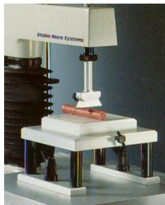
Εικόνα 4.10: Εξοπλισμός (Texture Analyzer, TA-XT2i, Stable Micro Systems, Godalming Surrey, UK) διεξαγωγής της ανάλυσης υφής σε δείγματα ελιών.
