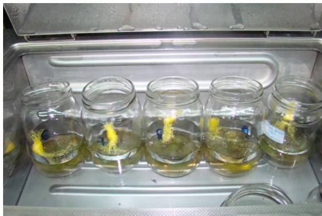
Εικόνα 4.1: Παραμονή πράσινων ελιών σε δοχεία με ωσμωτικό διάλυμα στους 25°C
