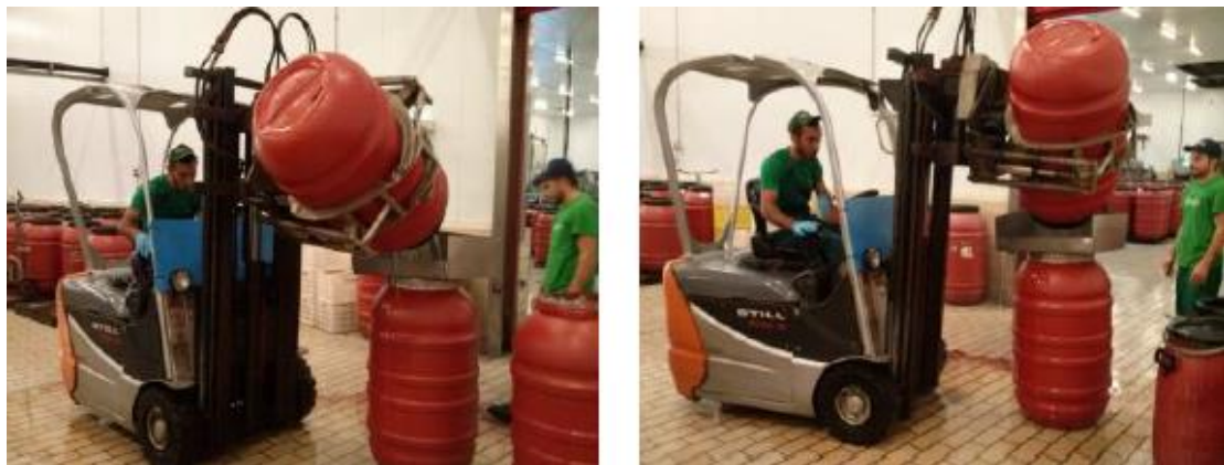
Εικόνα 4.4: Απομάκρυνση και αποστράγγιση των ελαιοκαρπών από το ωσμωτικό διάλυμα
