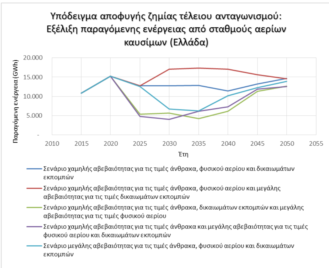
Γράφημα 12: Παραγόμενη ενέργεια σε GWh από σταθμούς αερίων καυσίμων όπως προέκυψε από την επίλυση του υποδείγματος μεγιστοποίησης της πιθανότητας αποφυγής ζημίας για την αγορά που αναπαριστά τον ηλεκτρικό τομέα της Ελλάδας
