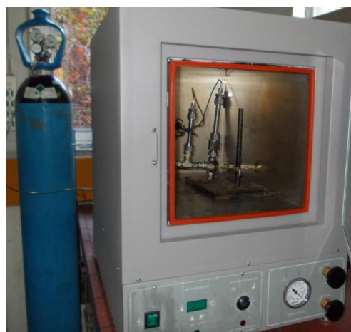
Εικόνα 4.9: Σχηματική διάταξη του συστήματος αντιδραστήρων στερεάς κλίνης
