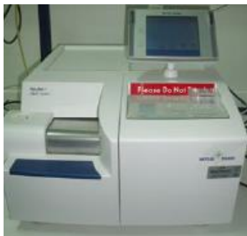
Εικόνα 4.27: Πειραματική διάταξη TGA
