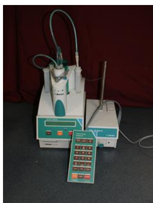
Εικόνα 4.19: Ο αυτόματος τιτλοδότης 716 DMS Titrimo της εταιρείας Brinkman Instruments, που χρησιμοποιήθηκε για τον προσδιορισμό της συγκέντρωσης των ακραίων ομάδων -COOH
