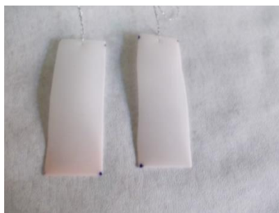
Εικόνα 4.13: Φύλλα PBS έπειτα από δοκιμή SSP
