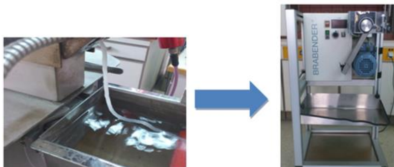
Εικόνα 4.15: Η εκβολή του PBS και η ψύξη του σε υδατόλουτρο. Ακολουθεί η κοπή του με τον κοκκοποιητή Brabender
