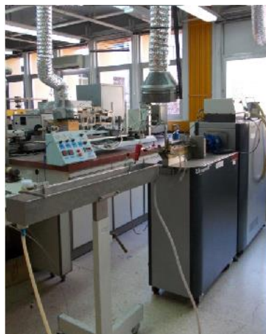
Εικόνα 4.14: Ο δικόχλιος ομόστροφος εκβολέας Haake (Rheomex PTW16p) της εταιρείας Thermo Fischer Scientific Inc.
