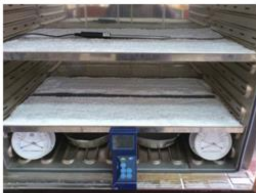
Εικόνα 4.8: Η προσυντήρηση του PBS σε φούρνο με υπέρκορο διάλυμα MgNO_3 \cdot (x \cdot 6H_2O)
