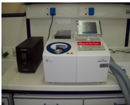
Εικόνα 4.24: Το σύστημα Mettler DSC 1STARe System που χρησιμοποιήθηκε για τις θερμικές αναλύσεις
