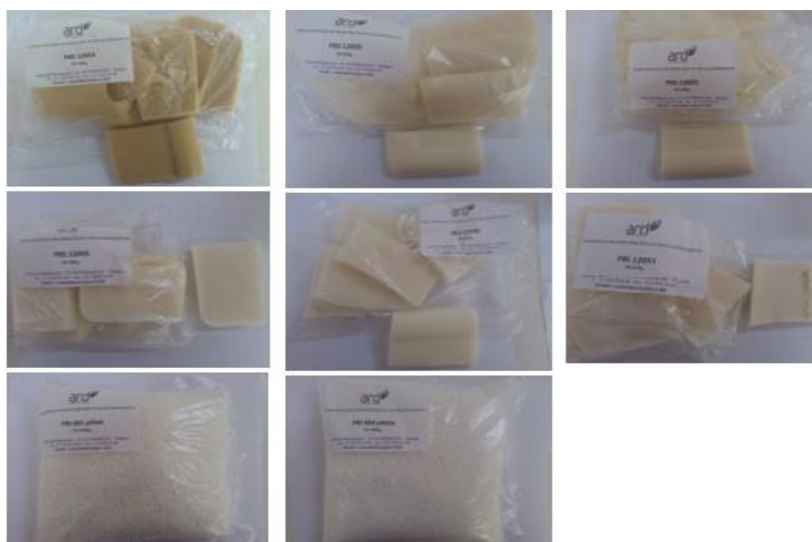
Εικόνα 4.4: Τα διάφορα προπολυμερή PBS της εταιρείας ARD για τη διεξαγωγή των πειραματικών δοκιμών SSP
