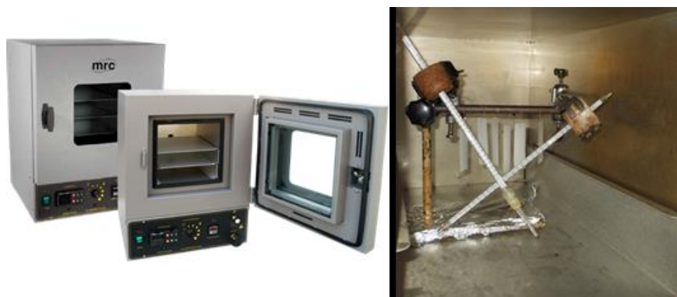
Εικόνα 4.12: Φούρνος mrc oven 1425/1445/1465 αριστερά και εσωτερικό του φούρνου με κατάλληλη διάταξη στήριξης δειγμάτων και θερμομέτρα ελέγχου θερμοκρασίας αντίδρασης, δεξιά
