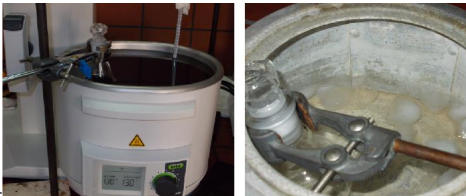
Εικόνα 4.18: Η απότομη ψύξη του τήγματος του PBS (quenching) προς περιορισμό της ανάπτυξης κρυσταλλικότητας
