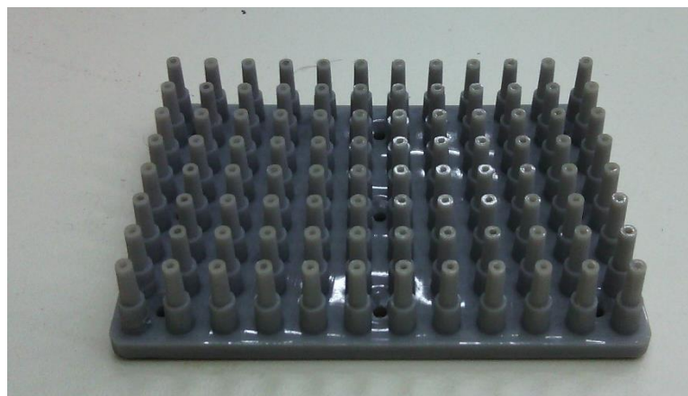
Σχήμα 50 Βάση για πιπέτες από 3D printing.
