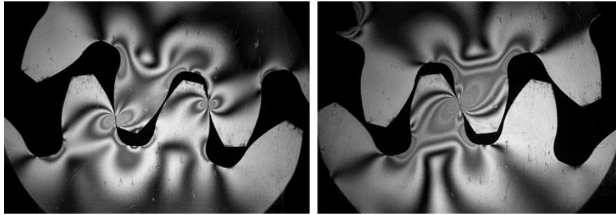
Σχήμα 30 Χρήση της μεθόδου της φωτοελαστικότητας για απεικόνιση των ισοχρωματικών μοτίβων της τάσης διπλού ζεύγους οδόντων (αριστερά) και απλού ζεύγους οδόντων (δεξιά). [18]
