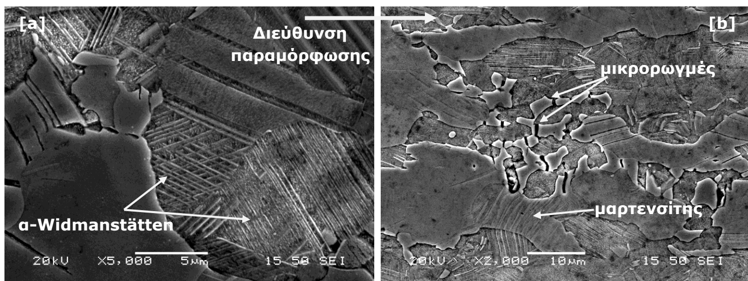
Εικόνα 5.5: Ηλεκτρονικές μικρογραφίες δευτερογενών ηλεκτρονίων, οι οποίες απεικονίζουν τη μικροδομή του ορείχαλκου ECO-Brass σε τομή παράλληλα στη διεύθυνση της ψυχρής παραμόρφωσης χωρίς θερμική κατεργασία (a) (14% παραμόρφωση) είναι εμφανής η α φάση με μορφολογία τύπου Widmanstätten, (b) (27% παραμόρφωση) μαρτενσιτικός μετασχηματισμός της κ φάσης και η παρουσία μικρορωγμών εντός της γ φάσης.
