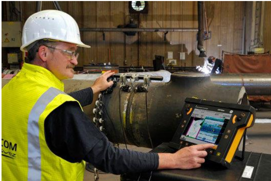
Εικόνα 8.4 Εφαρμογή υπερηχητικού ελέγχου
