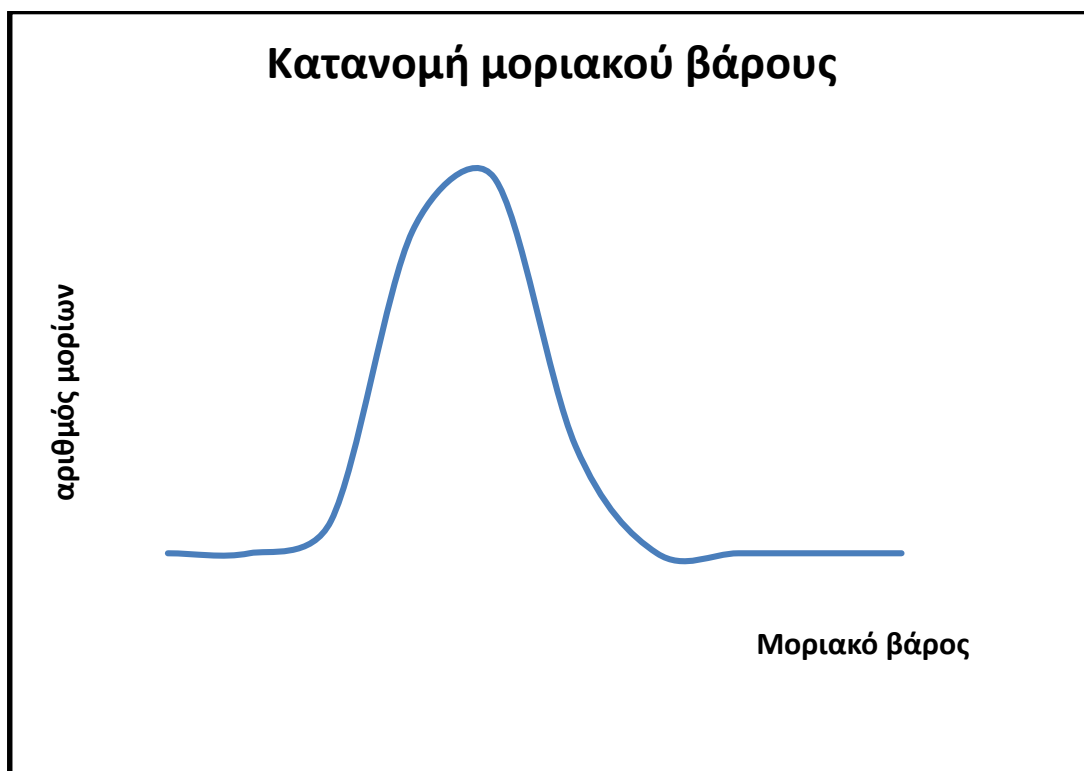
Σχήμα 1.10 Κατανομή μοριακού βάρους του πολυμερούς
